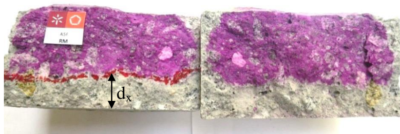
Figura 50: Profundidade da frente de carbonatação para o provete de referência.
