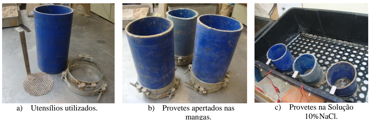
Figura 38: Colocação dos provetes na manga de borracha e introdução na solução 10%NaCl.
