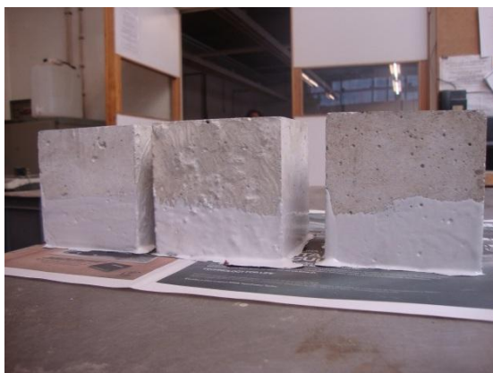
Figura 60: Proteção das faces das amostras. Figura 61: Provetes em ensaio de absorção capilar.
