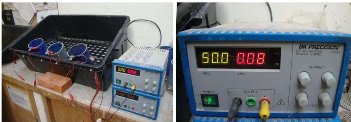
Figura 39: Sistema de ensaio ligado à fonte de alimentação após ajuste da voltagem.
