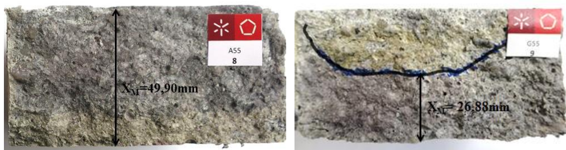
a) Penetração total dos cloretos para a amostra previamente carbonatada
