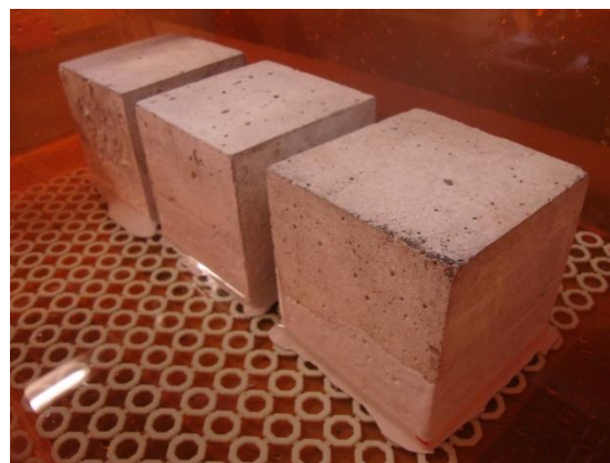
Figura 60: Proteção das faces das amostras. Figura 61: Provetes em ensaio de absorção capilar.
