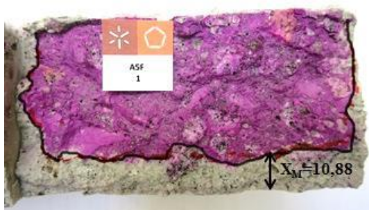
c) Frente carbonatada para o 1º mês da razão 0,5 CV
