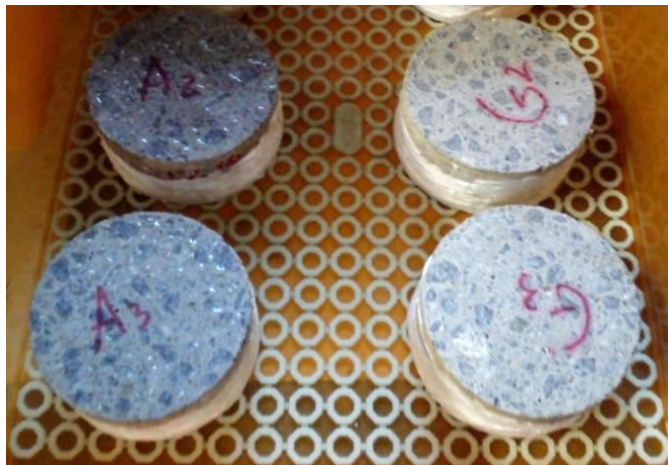
Figura 79: Provetes durante o ensaio de absorção capilar ao sexto dia. A- provetes submetidos previamente à ação combinada; G- provetes de referência.
