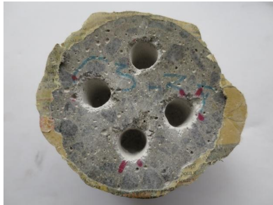
d) Aspeto final do provete recolhidas as amostras de pó nas 6 profundidades estudadas.
