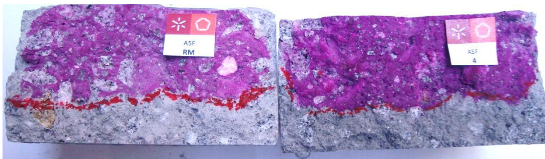
Figura 59: Comparação das frentes de carbonatação obtidas nos provetes de referência e no provete submetido ao ensaio de migração em regime não estacionário.
