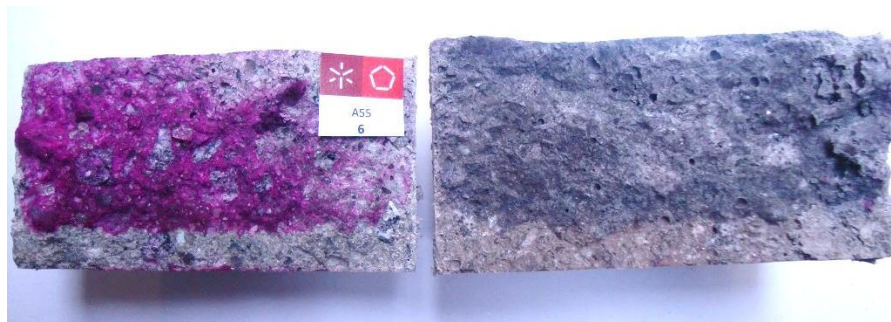
Figura 54: Identificação da profundidade de carbonatação e de penetração de cloretos nos provetes em provetes submetidos ao ensaio combinado por migração.
