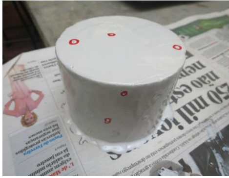
c) 3º Dia: identificação dos poros e pintura sobre os mesmos.
