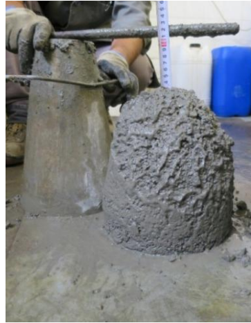
Figura 31: Abaixamento para a razão a/l 0,5 com incorporação de CV.
