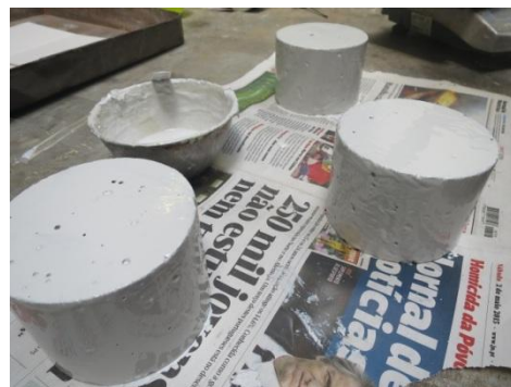
b) 2º Dia: cobrimento dos poros.
