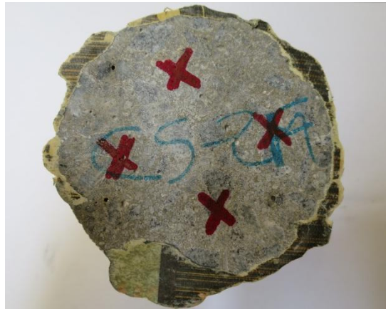
b) Marcação dos pontos para perfuração.
