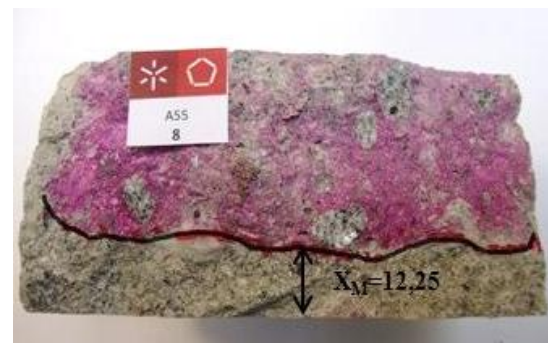
b) Frente carbonatada para o 3º mês da razão 0,55
