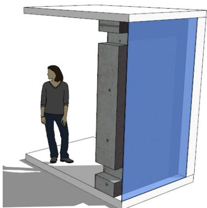
Figura 7 - Exemplo simples de parede de trombe ventilada.
