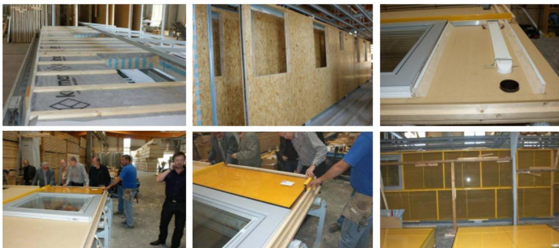
Figura 36 – Aspectos da linha de montagem da GAP, mostrando toda a fachada construída por módulos com os acessórios já devidamente fixados (gap-solution, 2014).
