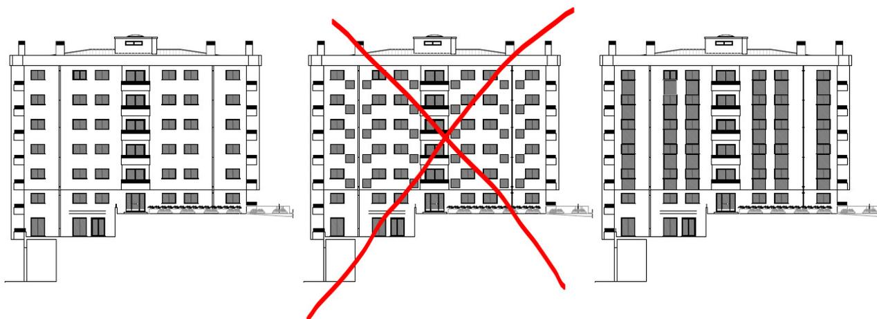
Figura 56 - Esquema exemplificativo das diversas possibilidades de integração arquitetónica, na imagem à esquerda o edifício original, na imagem ao centro a aplicação irregular de uma solução não dimensionada, na imagem à direita a aplicação de uma solução dimensionada ao edifício e aplicada respeitando a métrica pré-existente.
