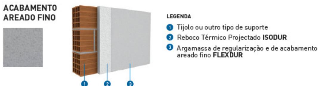
Figura 38 – Figura do sistema base do sistema ISODUR, mostrando os componentes a aplicar sobre a parede original de tijolo, fonte (Isodur)
