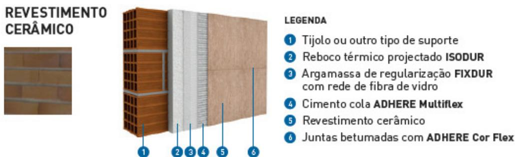
Figura 39 – Aplicação de cerâmica sobre o ISODUR (Isodur).
