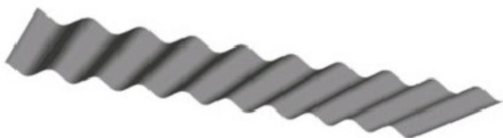
Figura 62 - Perfil de chapa de ferro zincado e lacada.
