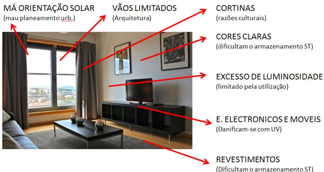
Figura 5 - Obstáculos ao aproveitamento térmico da radiação solar direta.
