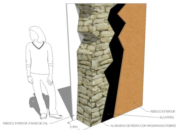
Figura 42 - Solução tipo de fachada 1900-1940.
