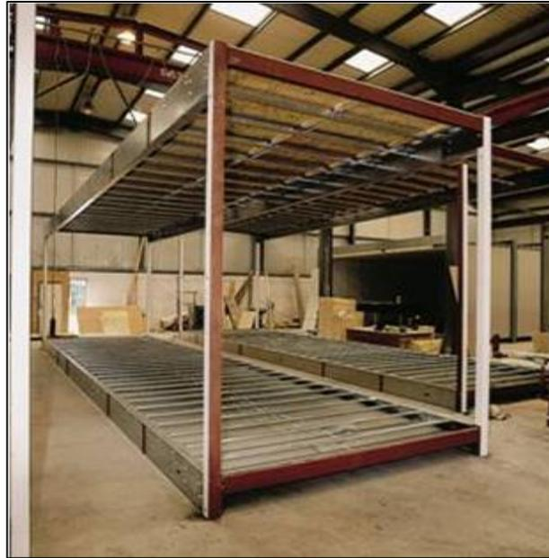
Figura 2-11: Sistema Modular Aberto. (SteelConstruction.info)
