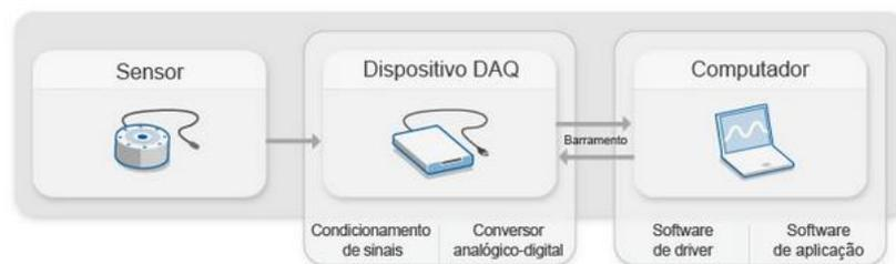
Figura 2.34 - Partes de um sistema de aquisição de dados
