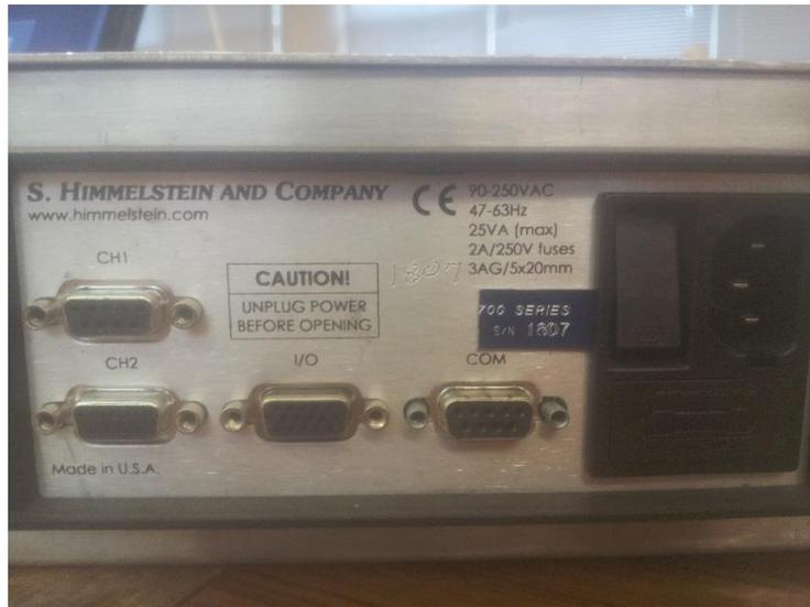
Figura 3.7 - Entradas e saídas do condicionador de sinal
