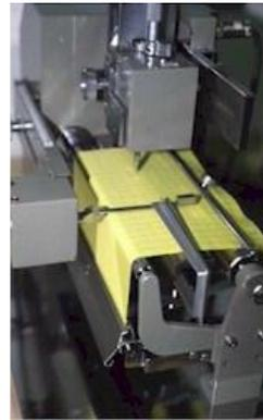
*Figura 2.5 - KES-FB4: Medidor de características de superfície*
