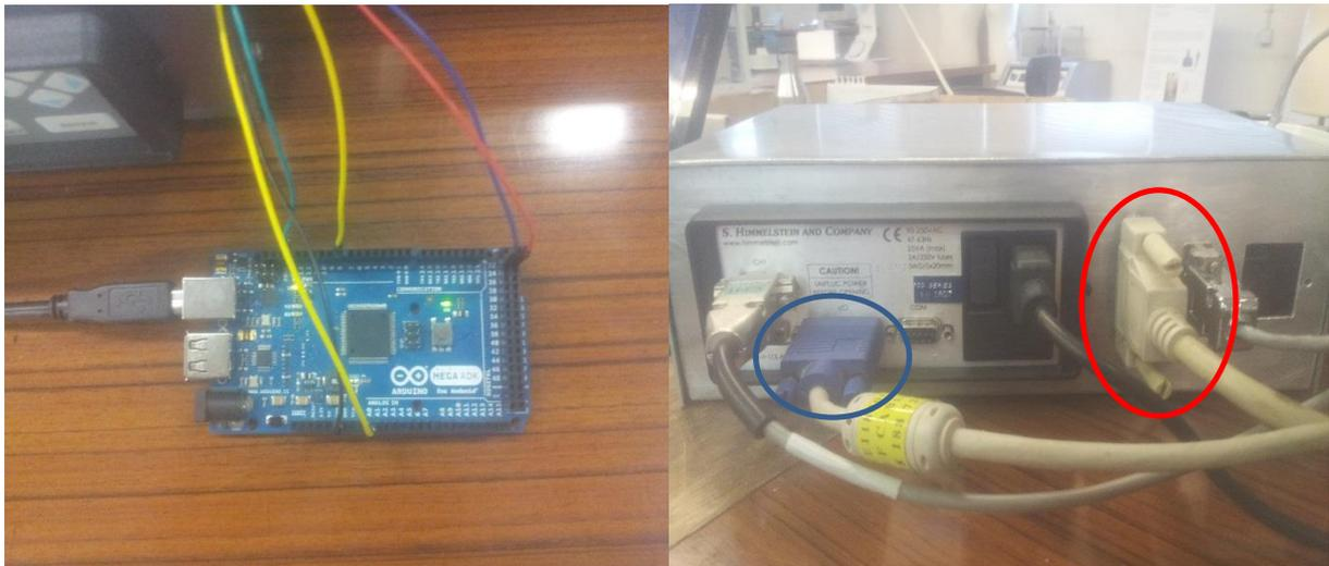
Figura 4.2 - Ligação Arduino com driver motor (vermelho) e condicionador (azul)
