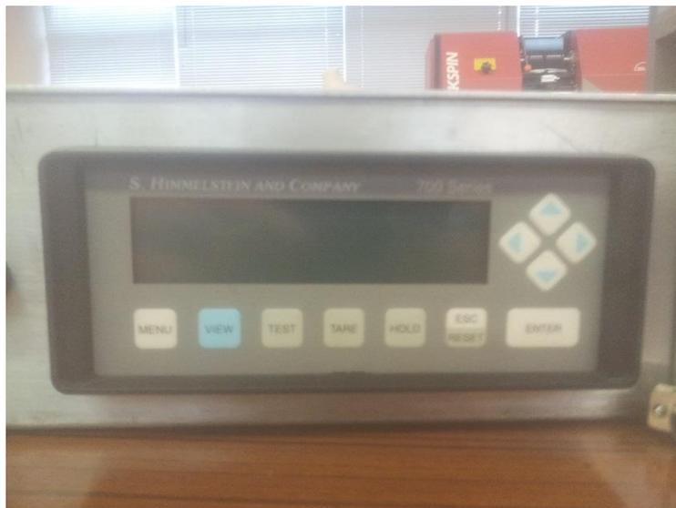
Figura 3.6 - Condicionador de sinal modelo 701
