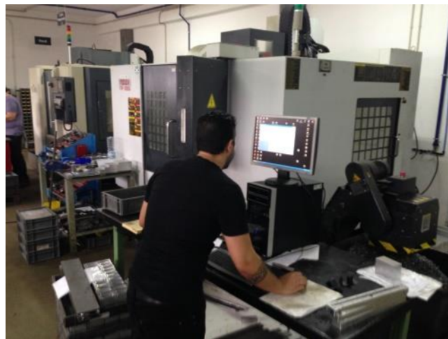
Figura 36 – Operário a programar junto da fresadora CNC na Preserie
