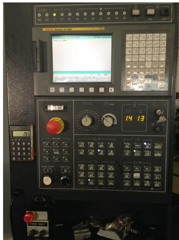
Figura 29 – Controlador da Fanuc Oi-MD
