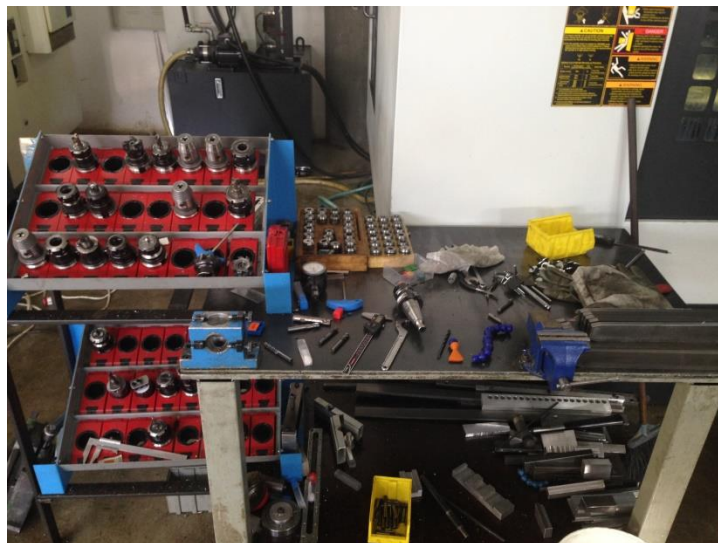
Figura 35 – Desorganização das ferramentas, apoios e chaves de aperto na Preserie
