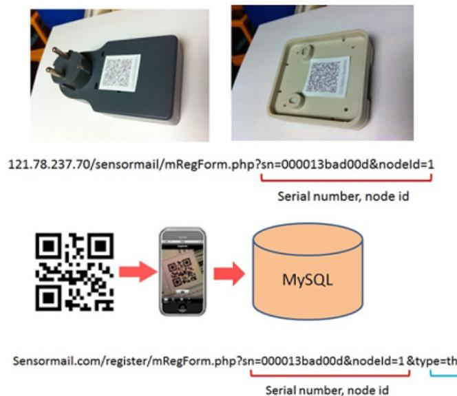
**Figura 2.12:** Implementação presente em [1] de um sistema de identificação de componentes utilizando *QR Codes*.
