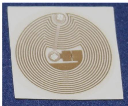
**Figura 2.18:** TAG NXP NTAG203 - 144 bytes, *Standard ISO 14443A* e Frequência de operação 13.56MHz
