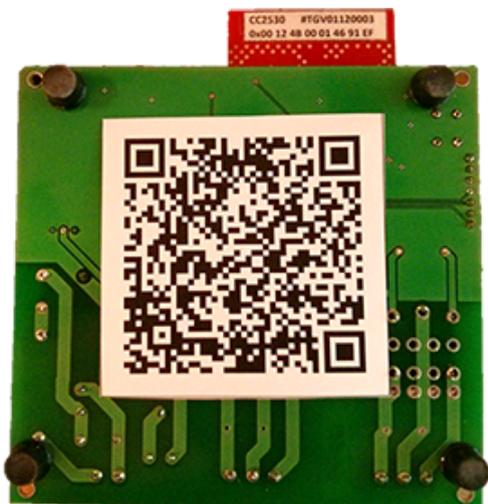
**Figura 5.32:** *Hardware* do nó com a *TAG QR Cde* anexada na parte inferior da placa.
