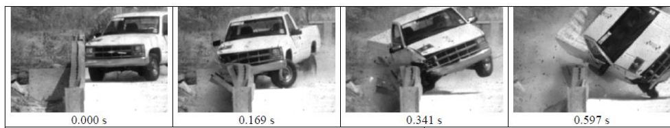
Figura 4.11-Teste em guarda de segurança de betão [19]
