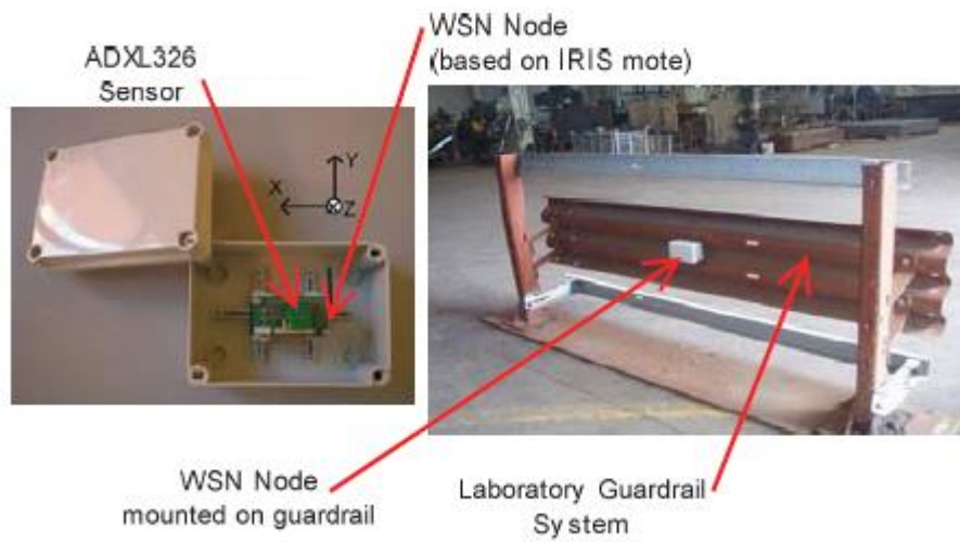
Figura 2.3-Protótipo de um nó para deteção de colisões [1]
