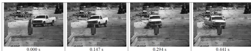
Figura 4.12-Teste em guarda de segurança metálico [19]
