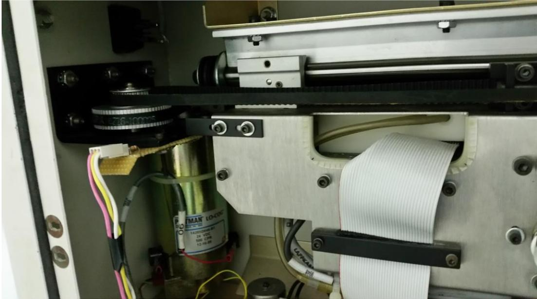
**Figura 4.5 - Motor do eixo dos xx.**
