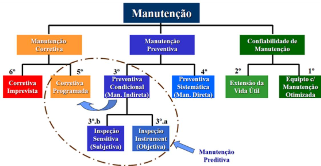
Figura 2.41 - Esquema dos tipos de manutenções. Adaptado de [10].
