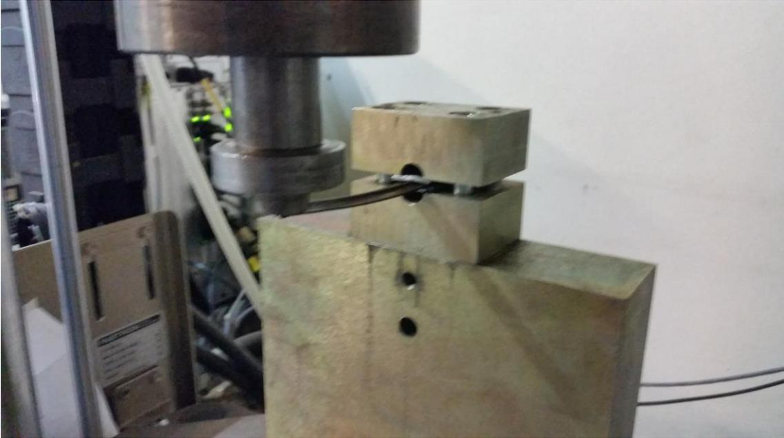
Figura 3.19 – Montagem do ensaio de flexão
