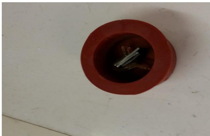
Figura 3.13 – Recipiente com amostra em resina
