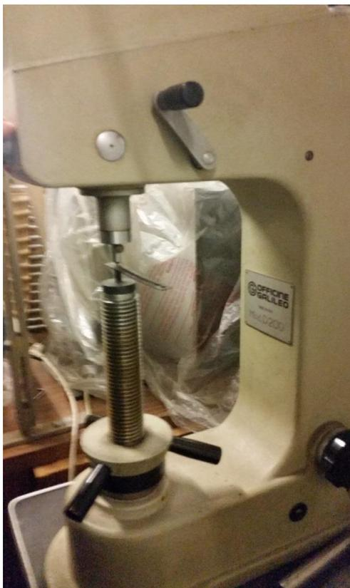
Figura 3.11 - Ensaio de dureza Rockwell C
