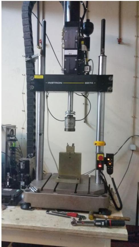
Figura 3.17 - Máquina utilizada para ensaios de flexão
