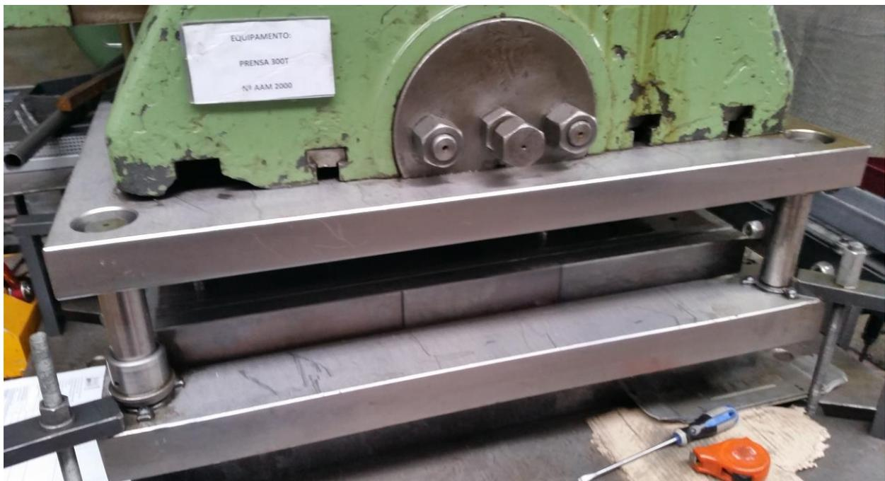
Figura 4.22 - Prensa utilizada para aplicação da nervura
