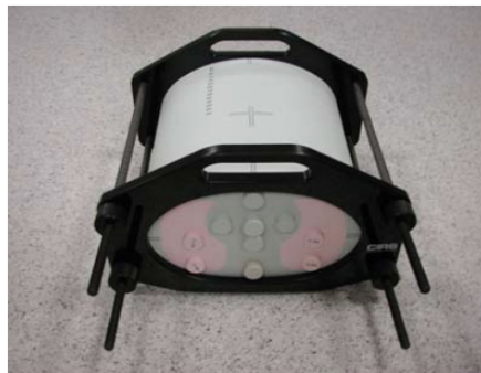
Figura 2.14- Fantôma CIRS Thorax (Modelo 002LFC) [2].
