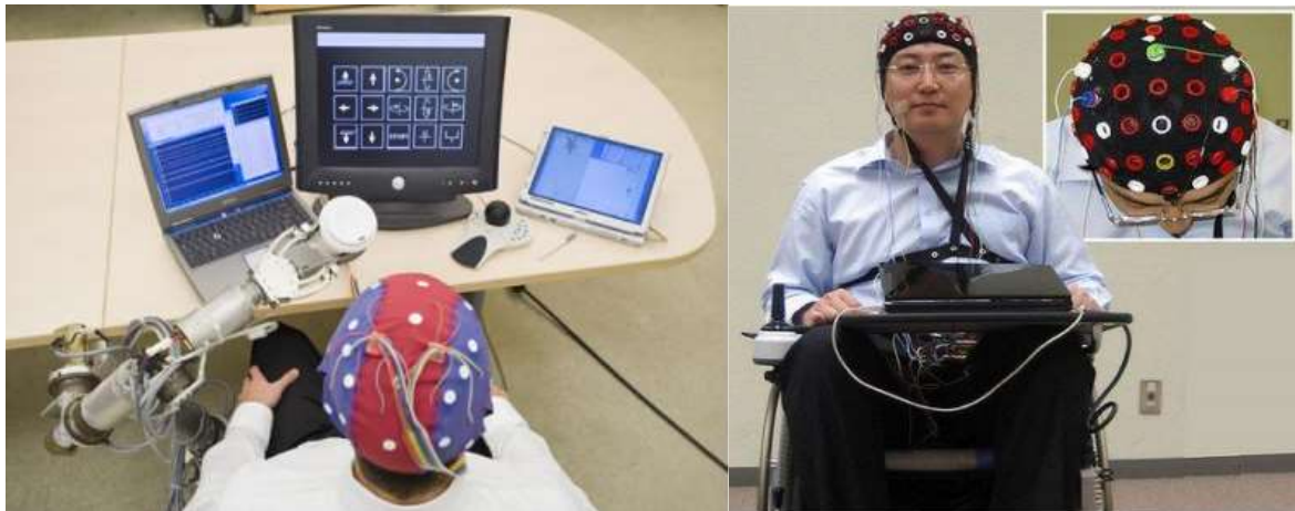
Figura 11 - Protótipo de braço robótico e CRI controlados por ondas cerebrais
