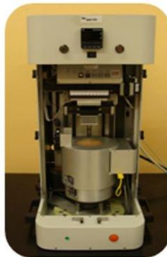
Figura 2.8 - Tribómetro Bruker UMT-2
