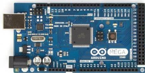
**Figura 2.19 - Placa Arduino Mega 2560**
