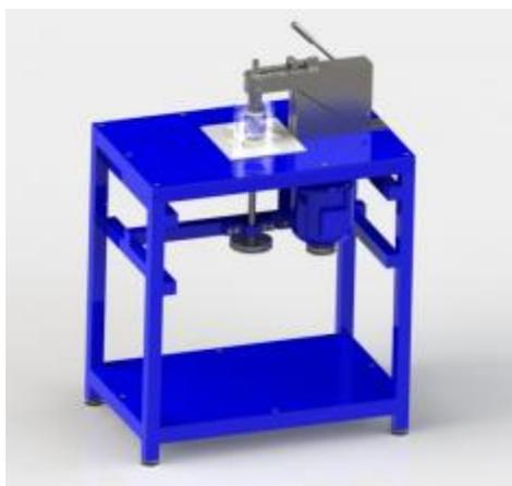
Figura 2.10 - Tribómetro Pino-Disco invertido
