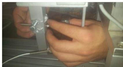
**Figura 6.5 - Calibração manual da célula de carga**
