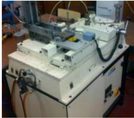
Figura 2.9 - Tribómetro PLINT TE 67/R
