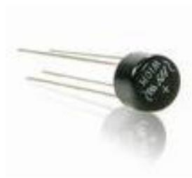
**Figura 4.15 - Ponte retificadora utilizada**
