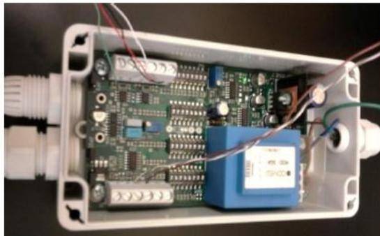
**Figura 3.9 - Amplificador da célula de carga**
