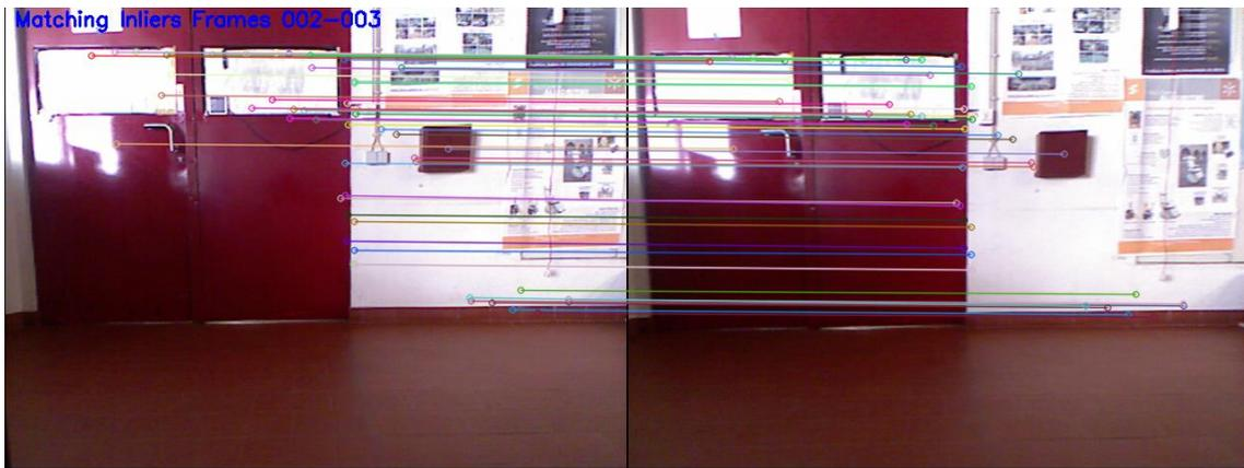
Figura 4.6: Correspondência entre imagens depois de aplicado o algoritmo RANSAC.
