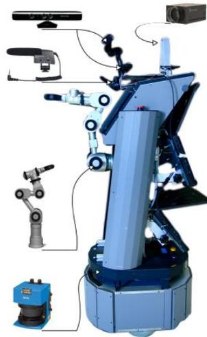
Figura 2.5: ToBi com os seus componentes: câmara, sensores 3D, LRF, e ainda um braço robótico KATANA e microfone. [12]
