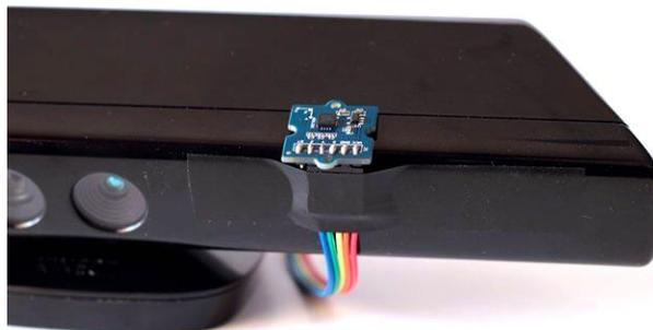
Figura 4.7: Acelerómetro de três eixos (ADXL335), montado sobre o sensor *Kinect*.
