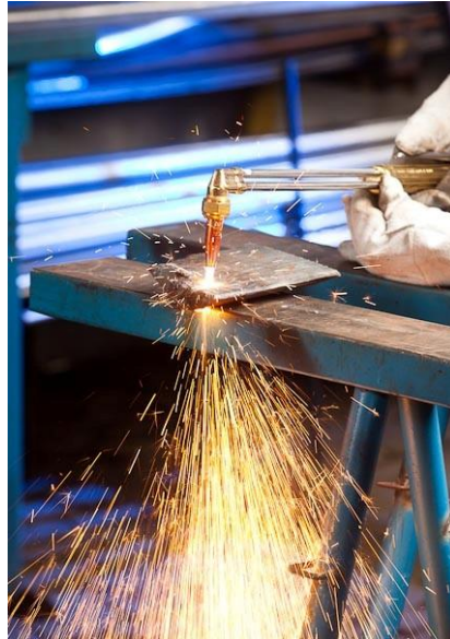
Figura 3.4 - Operação de Oxicorte [52]
