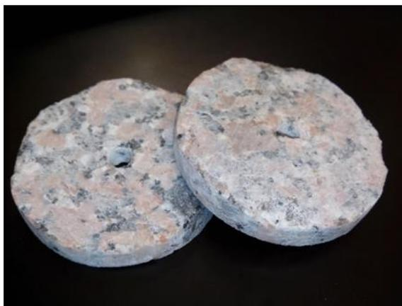
Figura 24 - Discos de granito utilizados nos testes de desgaste contra pedra.
