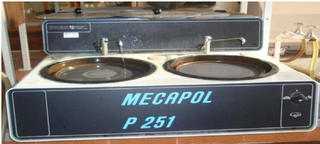
Figura 17 - Equipamento utilizado para o polimento das amostras produzidas (MECAPOL P251).
