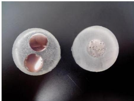
Figura 16 - Amostras montadas em resina.
