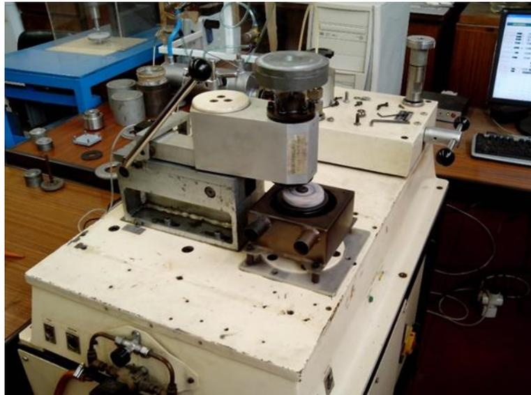
Figura 25 - Ensaio de desgaste contra discos de granito.
