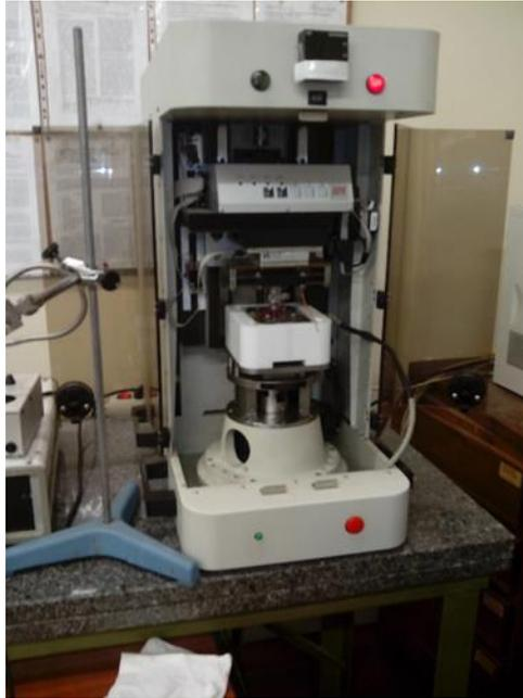
Figura 23 - Ensaio de desgaste contra esferas de alumina realizados no tribômetro CETR UMT-2.
