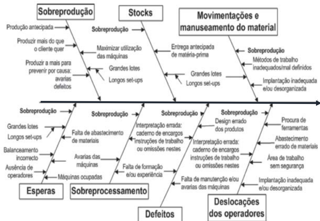
Figura 4 – Representação esquemática do diagrama causa-efeito dos sete desperdícios (causas) e o seu efeito (Maia et al., 2012)
