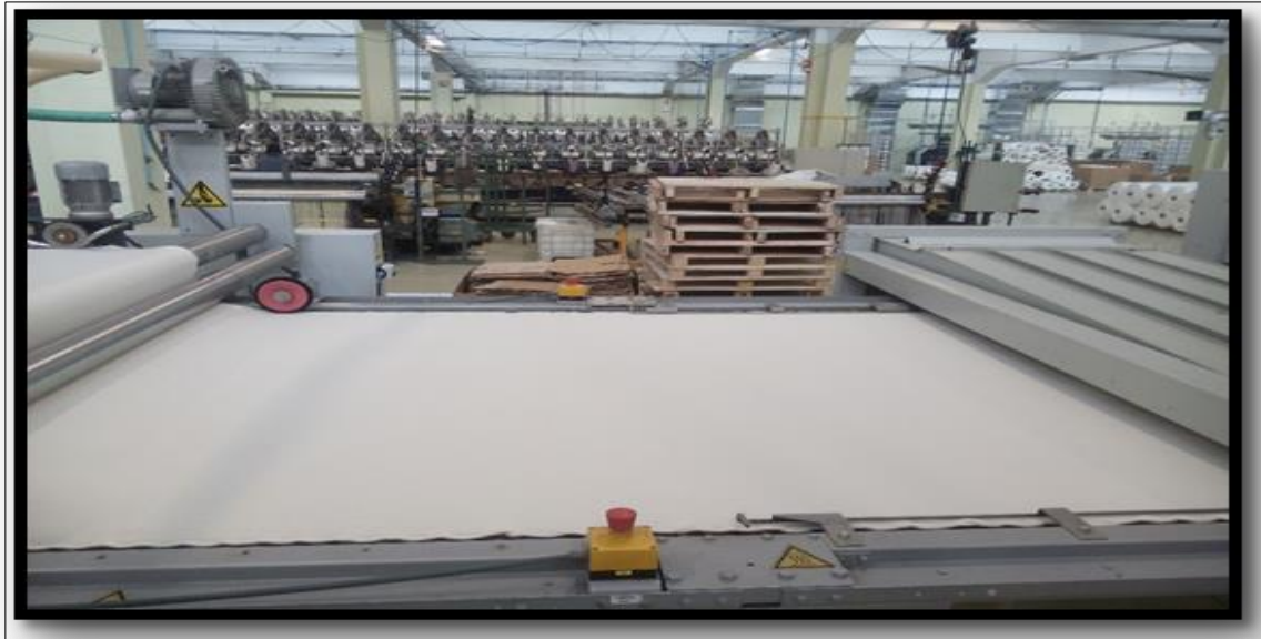
Figura 12 - Exemplificação do processo de produção das Malhas - Râmula
