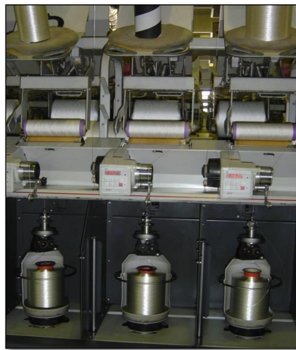
Figura 7 - Exemplificação do processo de Torcedura
