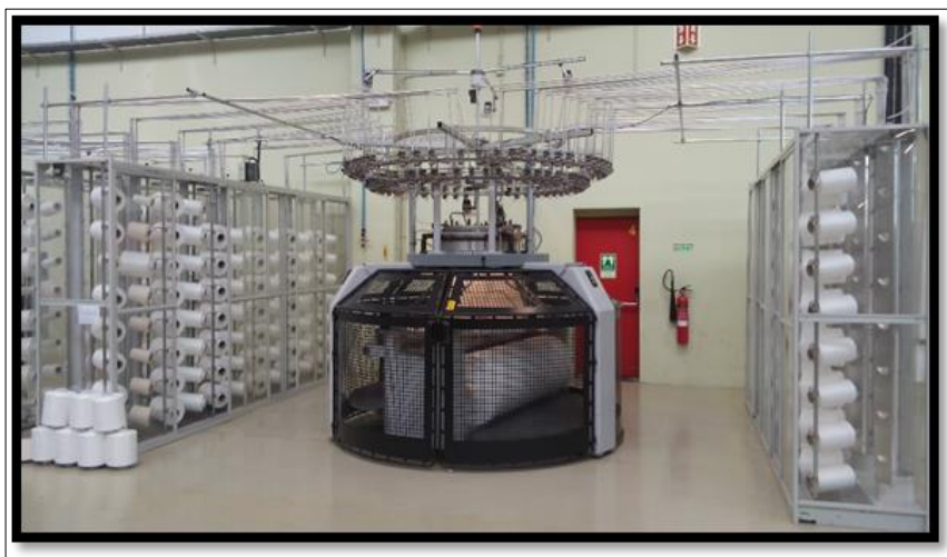
Figura 11 - Exemplificação do processo de produção das Malhas – Tear Circular
