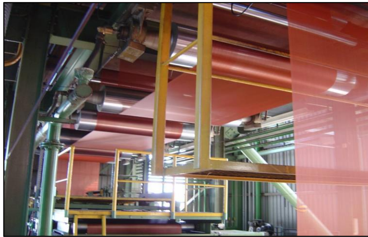
Figura 9 - Exemplificação do processo de Impregnação do Rolo
