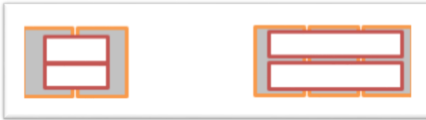
Figura 29 - Exemplos de colocação de tabuas em 2 e 3 Base-Boards
