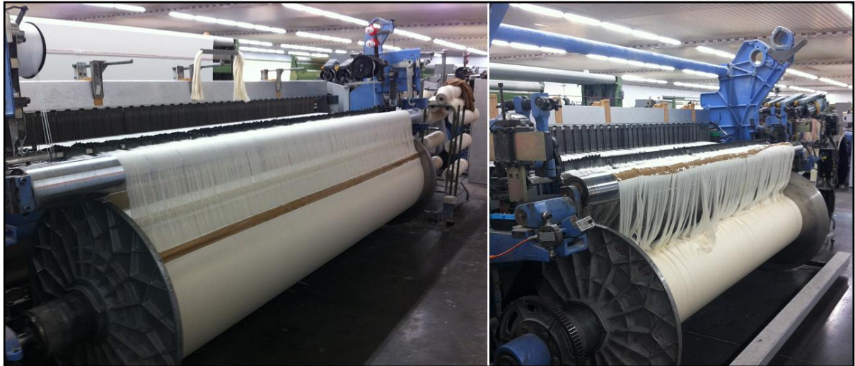
Figura 28 - Exemplo de tear de maquineta (mais exemplo de suporte para órgão superior à direita)
