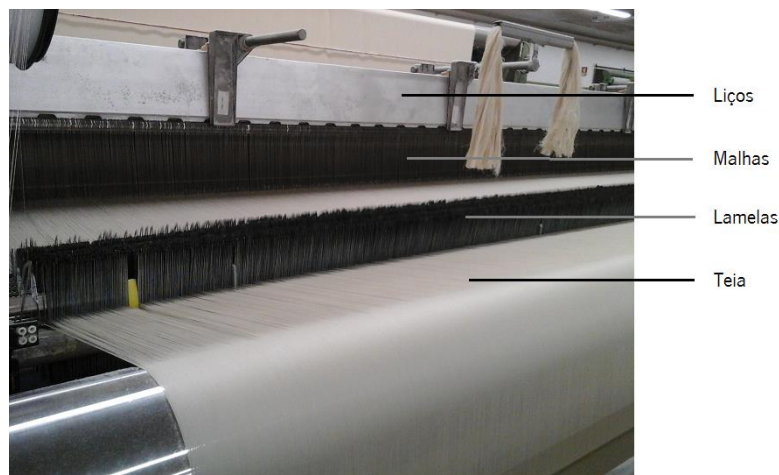
Figura 27 - Exemplificação de lamelas, malhas e liços, em tear de excêntrico
