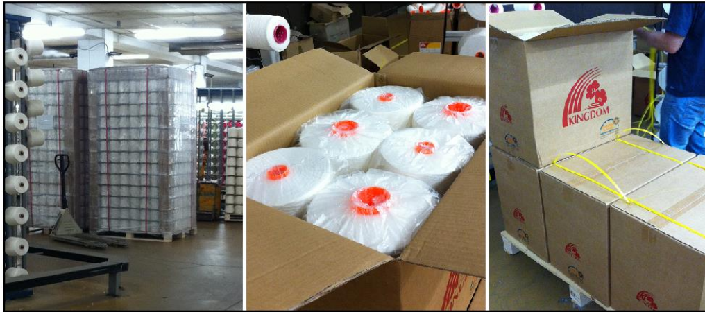
Figura 36 - Exemplos de excesso de taras
