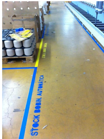
Figura 46 - Exemplo para stock de paletes para bobinadeira automática e para bobinadeira manual
