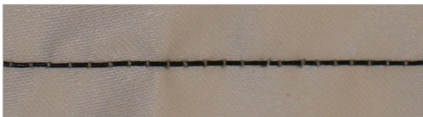
Figura 47. Costura realizada com TPU + 4% NTC (Ponto 301)
