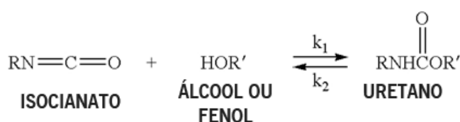
Figura 20. Equação química de obtenção de Uretano
