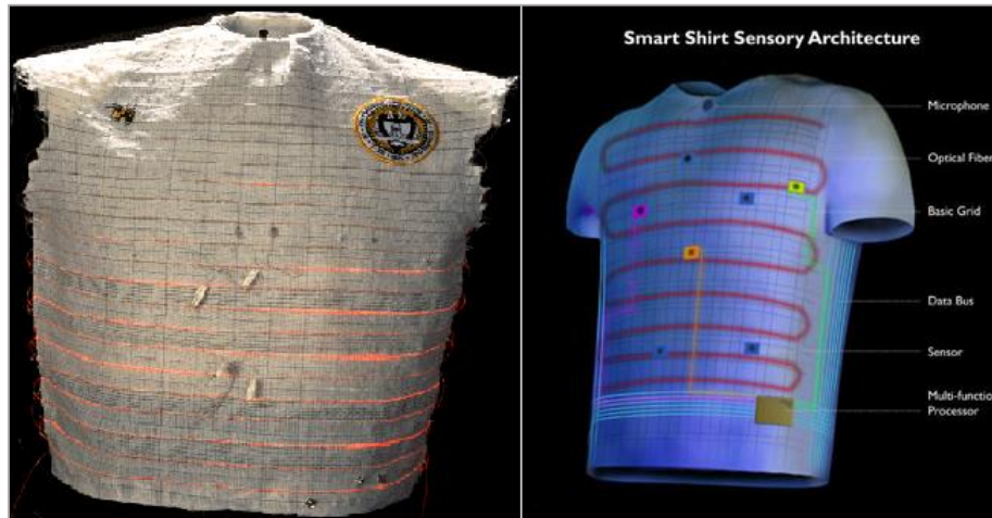
Figura 14. Protótipo e esquema de funcionamento da Smartshirt [156]
