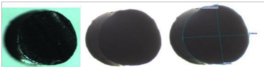
Figura 60. Vista ao microscópio da secção transversal de um filamento de (PCL + 4% NTC)/PP [50/50]
