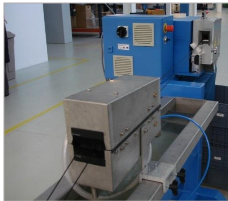
Figura 30. Zona de secagem (em primeiro plano) e a granulação a frio (em segundo plano)
