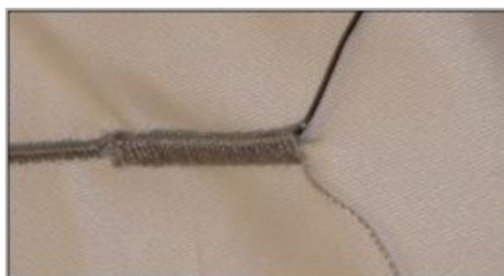
Figura 47. Costura realizada com TPU + 4% NTC (Ponto 301)
