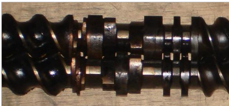
Figura 26. Pormenor da diferença entre bloco de mistura com escalonamento diferente
