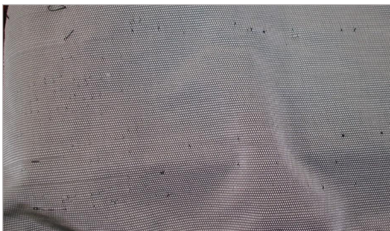
Figura 37. Defeitos resultantes da falha de passagem de trama entre as pinças
