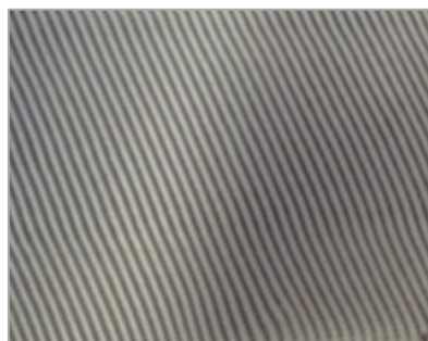
Figura 41. Tecido obtido com monofilamento (sarja invertida) com 13 passagens / cm
