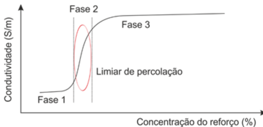
Figura 5. Curva de percolação elétrica (adaptado de [68]).
