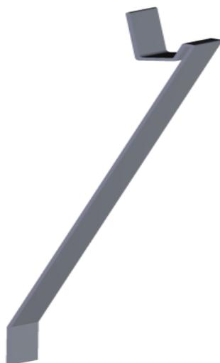
**Figura 4.58 – Modelo CAD da haste de suporte à tampa da gaiola.**
