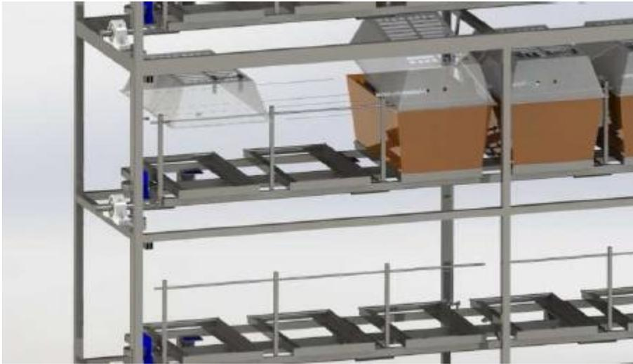
**Figura 3.5 – Sistema de suporte da parte superior das gaiolas (retirado de [14]).**
