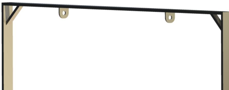
**Figura 4.61 – Reforço em triângulo do pórtico desenvolvido.**
