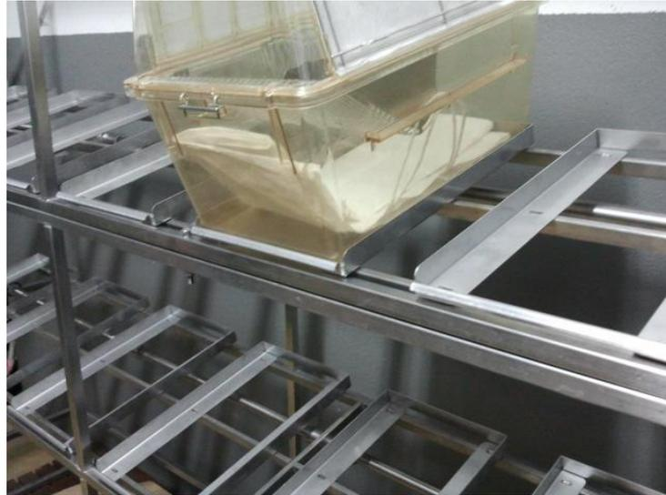
**Figura 3.7 – Pormenor do encaixe da gaiola nos suportes.**
