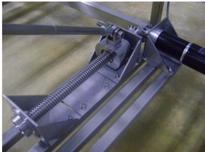
**Figura 3.9 – Ligação do motor ao sistema porca-parafuso**
