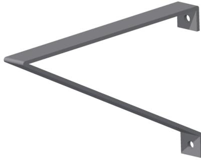
**Figura 4.52 – Elemento de suporte às tubagens do sistema de distribuição de água.**
