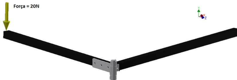
**Figura 4.55 – Aplicação da força de 20N na extremidade da barra móvel.**
