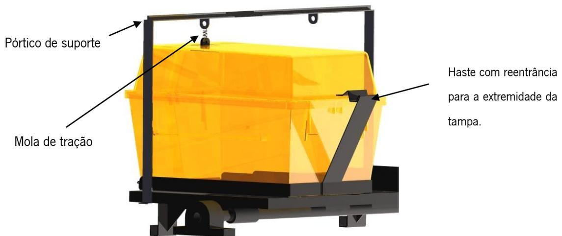
**Figura 4.57 – Elementos estruturais de suporte à tampa da gaiola.**
