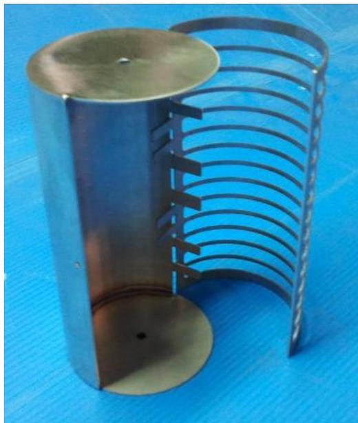
**Figura 3.15 – Solução para o *Inaccessible Food* – Comedouro rotativo.**
