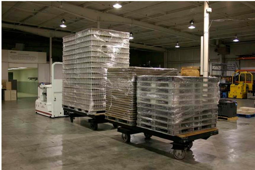
Figura 4- AGV de Reboque
