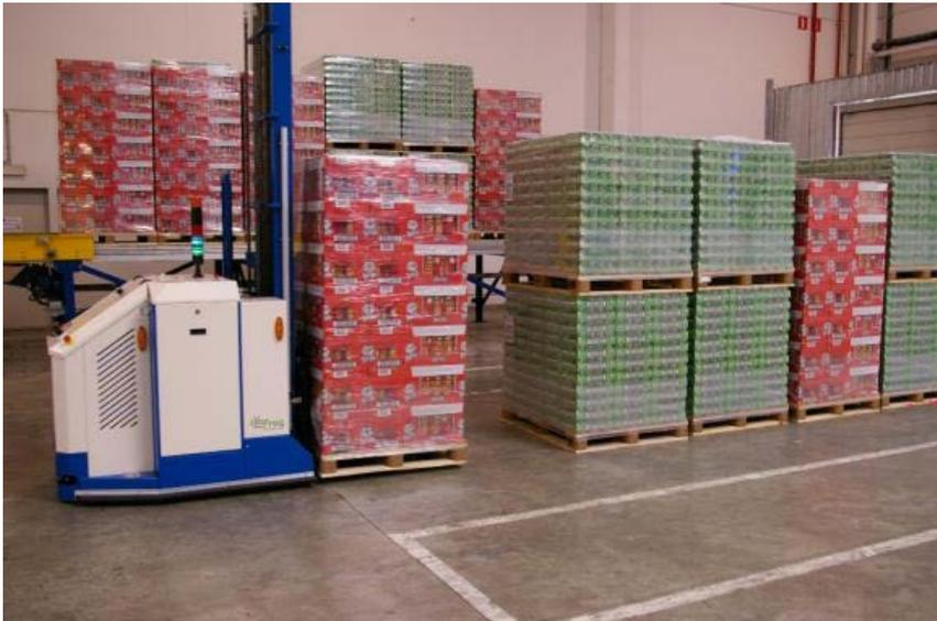
Figura 2-AGV usado para transportar paletes num armazém
