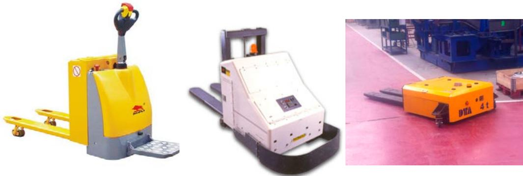
Figura 5-Da esquerda para a direita: porta paletes com opção de controlo manual, porta paletes sem controlo manual
