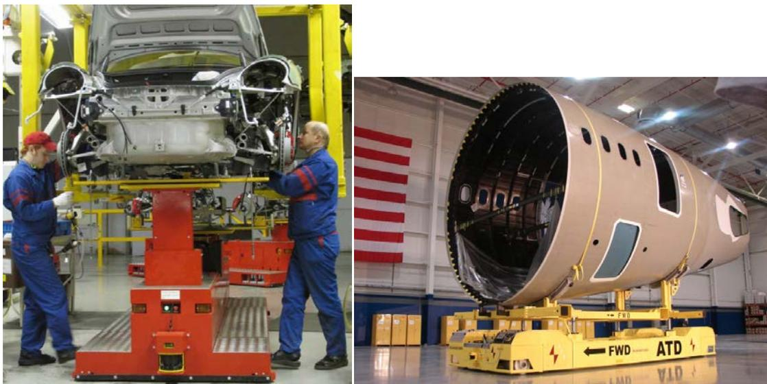
Figura 1- Da esquerda para a direita: *AGV* utilizado na montagem de automóvel, *AGV* utilizado na montagem de um avião
