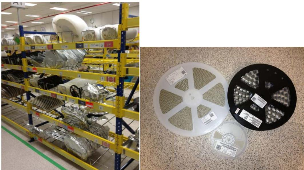
Figura 20-As bobines de componentes elétricos são armazenadas diretamente em estantes.
