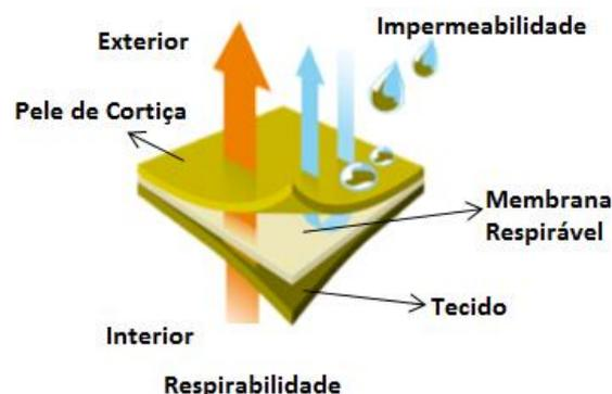
Figura 1: Trilaminado – Pele de Cortiça / Membrana Respirável / Tecido
