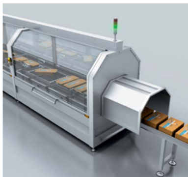
Figura 2.35: Exemplo de impedimento do acesso de maneira permanente. Extraído de (7).
