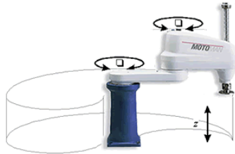
Figura 3.11: Exemplo de um robô do tipo Scara . Extraído de (21).
