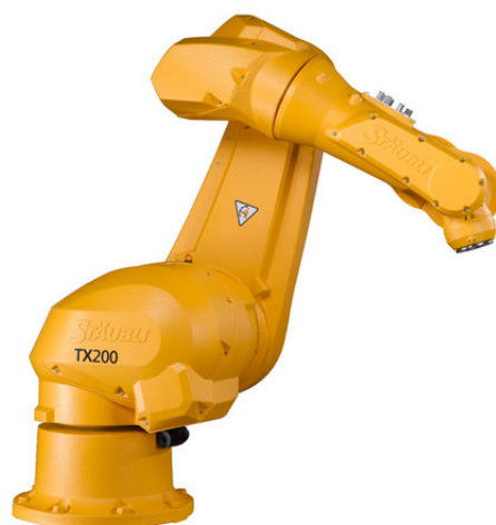
Figura 3.12: Exemplo de um robô do tipo braço robótico da marca Staubli . Extraído de (23).
