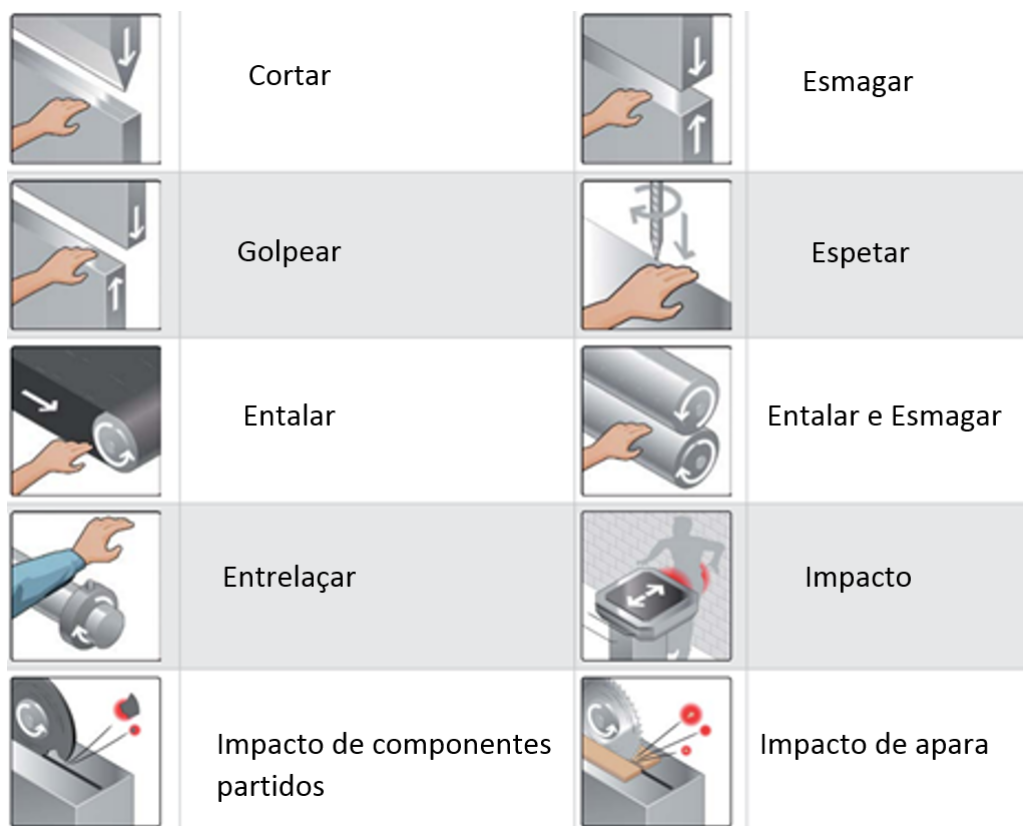
Figura 2.29: Exemplos de possíveis perigos presentes nos equipamentos. Adaptado de (7).
