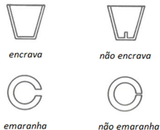
Figura 2.18: Exemplos de componentes que têm tendência a encravar e emaranhar. Adaptado de (6).
