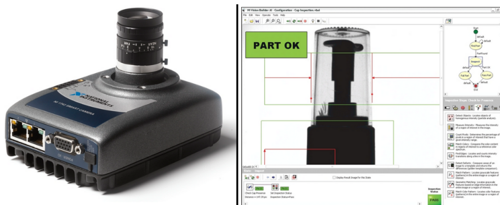
Figura 3.21: Exemplo de smartcamera da National Instruments na figura à esquerda, e na figura da direita o software de programação da mesma existentes no mercado. Extraído de (30).
