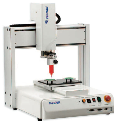
Figura 3.10: Exemplo de uma configuração com mesa cartesiana. Extraído de (22).
