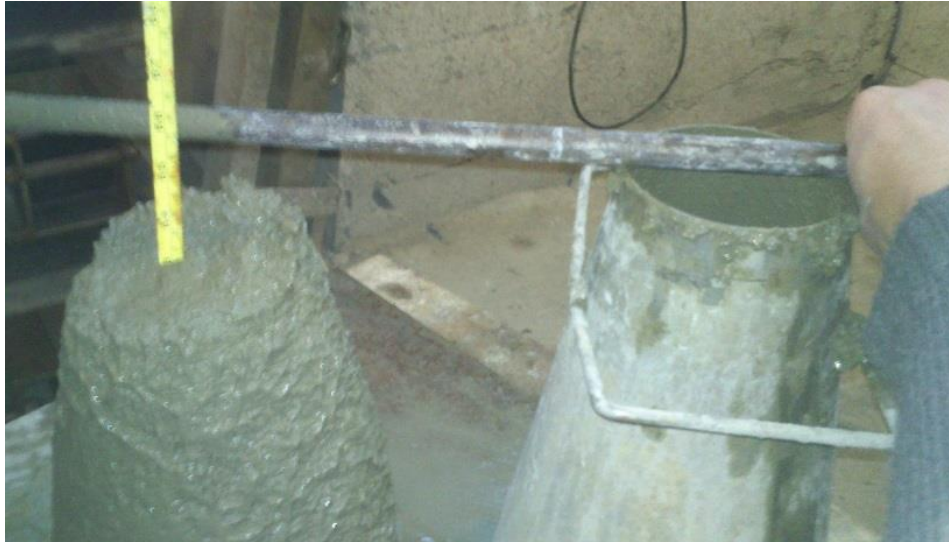
Figura 3.13 – Procedimento para fazer a medição
