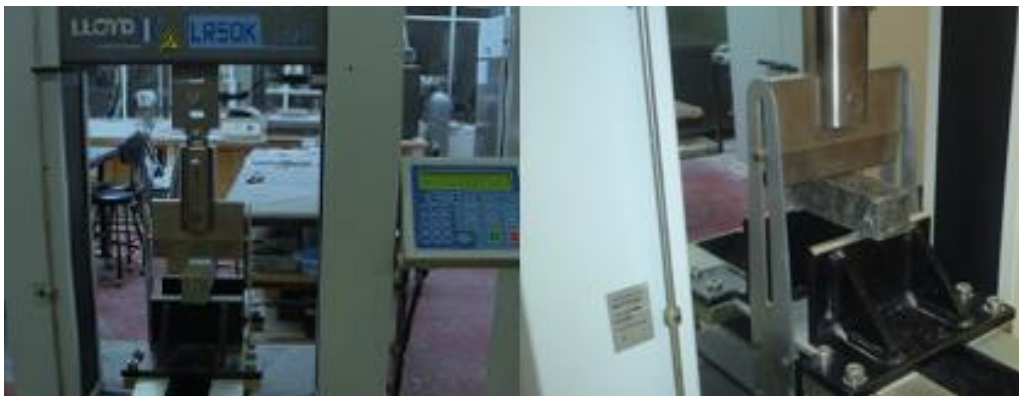
Figura 3.14 – Equipamento usado para o ensaio de flexão
