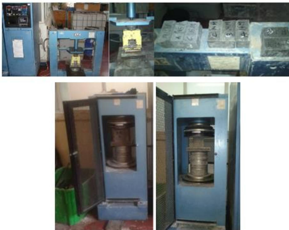
Figura 3.15 – Equipamento utilizado no ensaio de compressão
