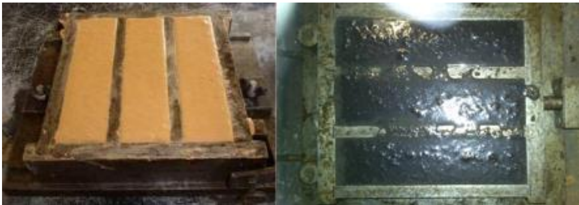
Figura 3.6 – Moldagem dos provetes
