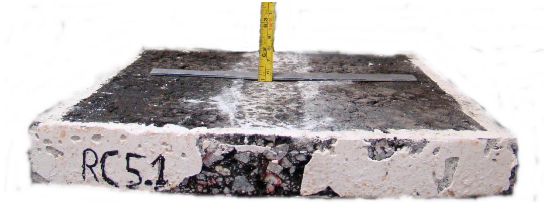
Figura 4.25: Rodeira da laje produzida com a mistura P5 (5% de PEAD)
