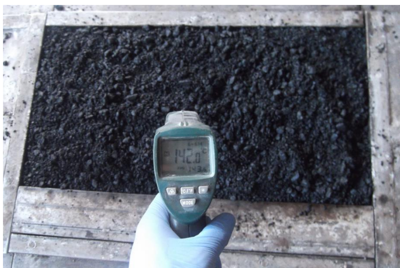
Figura 3.18: Temperatura de compactação de uma laje para avaliar a resistência à deformação permanente
