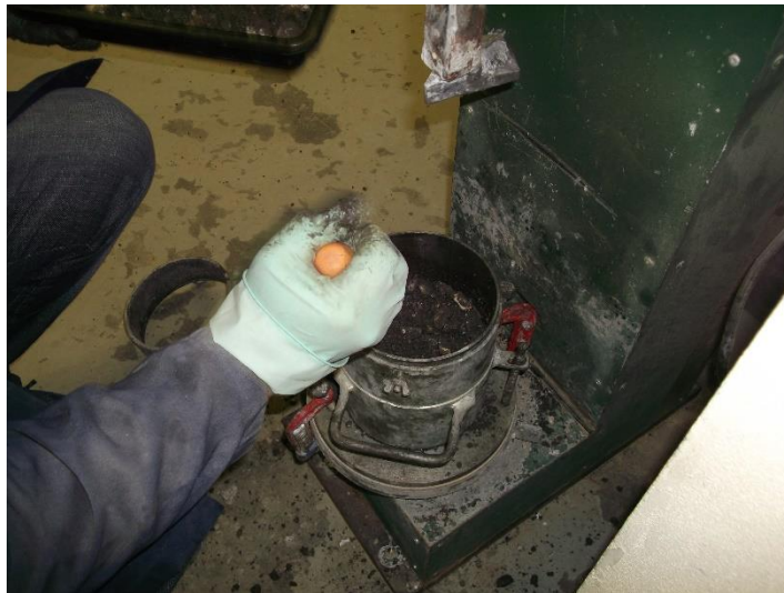
Figura 14 - Camada a ser escarificada.
