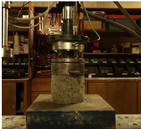
Figura 20 - Ensaio de Compressão Simples com rótula plástica.
