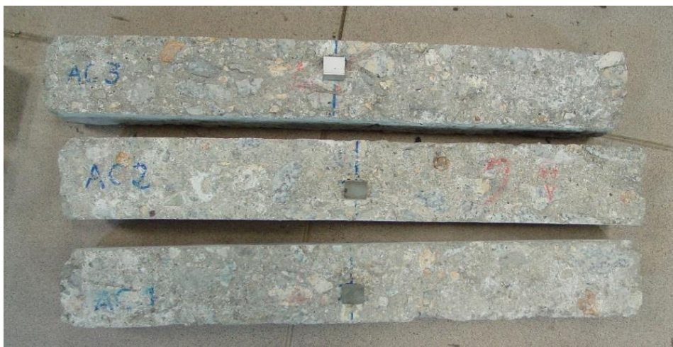
Figura 19 - Vigas cortadas de uma lajeta (Agregado/Cinzas).
