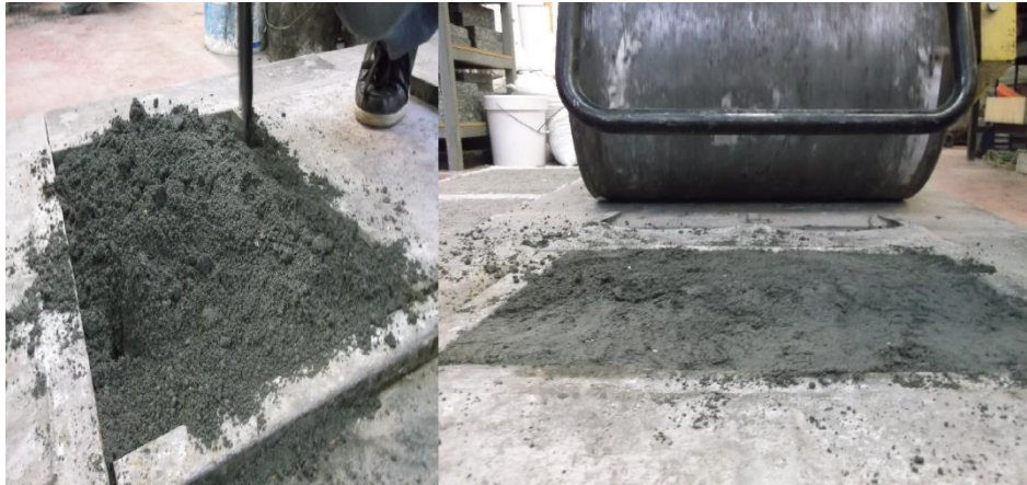
Figura 18 - Enchimento do molde e compactação da mistura com cilindro de rasto liso.
