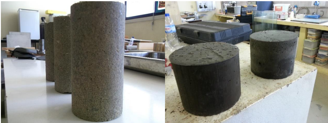
Figura 12 - Provetes de solo (esquerda) e provetes de agregado (direita).
