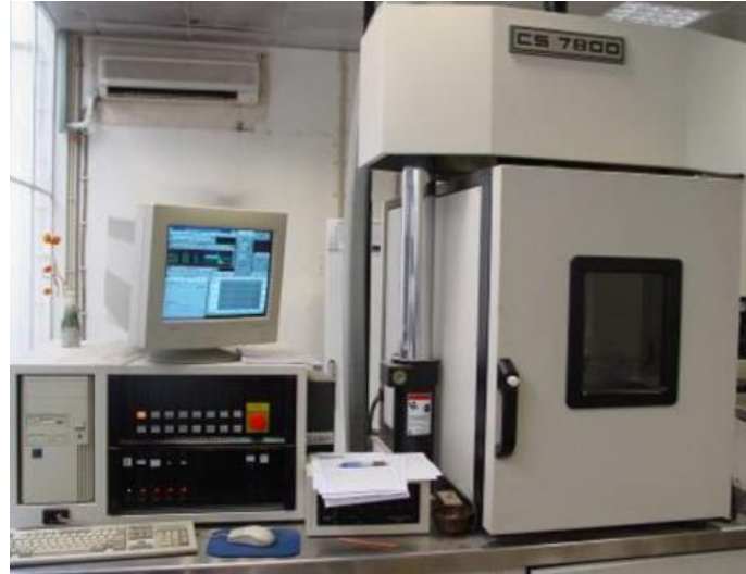
Figura 22 - Equipamento servo-hidráulico utilizado no ensaio do módulo de elasticidade (Palha, 2007).
