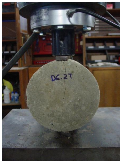
Figura 21 - Rotura de um provete agregado/cimento durante o ensaio à tração indireta.
