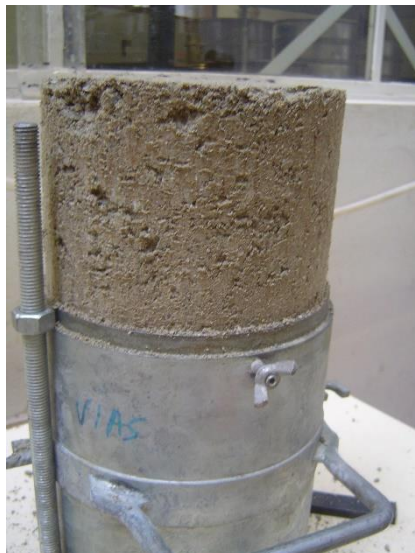
Figura 15 - Provete a ser desmoldado numa prensa hidráulica.
