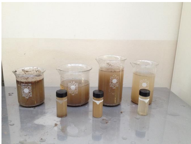
Figura 5.25 – Amostras de água com um Volume de Resíduos de 250 mL e 20 folhas
