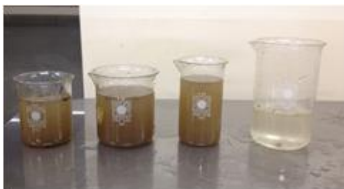
Figura 5.18 – Amostras de água com um Volume de Resíduos de 125 mL e 40 folhas
