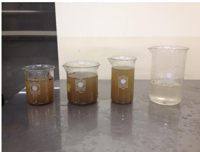
Figura 5.17 – Amostras de água com um Volume de Resíduos de 125 mL e 20 folhas
