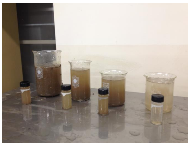
Figura 5.34 – Amostras de água com um Volume de Resíduos de 400 mL e 40 folhas
