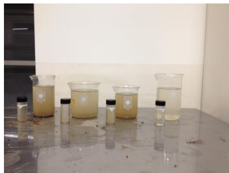
Figura 5.2 – Amostras de água com um Volume de Resíduos de 50 mL e 40 folhas
