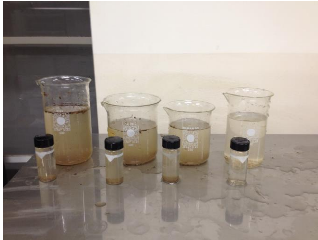
Figura 5.9 – Amostras de água com um Volume de Resíduos de 75 mL e 20 folhas
