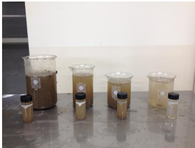
Figura 5.33 – Amostras de água com um Volume de Resíduos de 400 mL e 20 folhas
