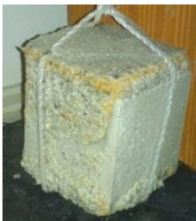
Figura 4.13 – Provede de betão revestido com argamassa geopolimérica a base de metacaulino um dia após contacto com o ácido sulfúrico (C=30%)
