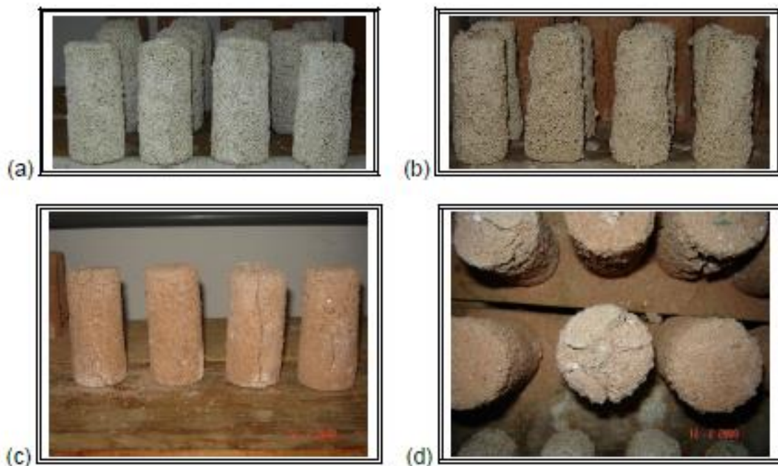
Figura 2.6 - Provetes submersos numa solução de ácido sulfúrico com uma concentração de 10% : (a) e (b) argamassa de cimento Portland; (c) e (d) argamassa geopolimérica (Dias, 2008)
