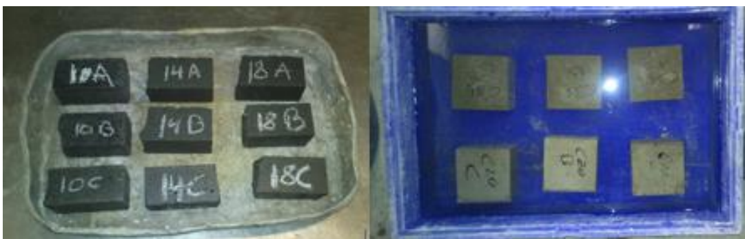
Figura 3.16 – Provetes utilizados no ensaio (lado esquerdo – Argamassas geopoliméricas; lado direito – Betões de cimento Portland)
