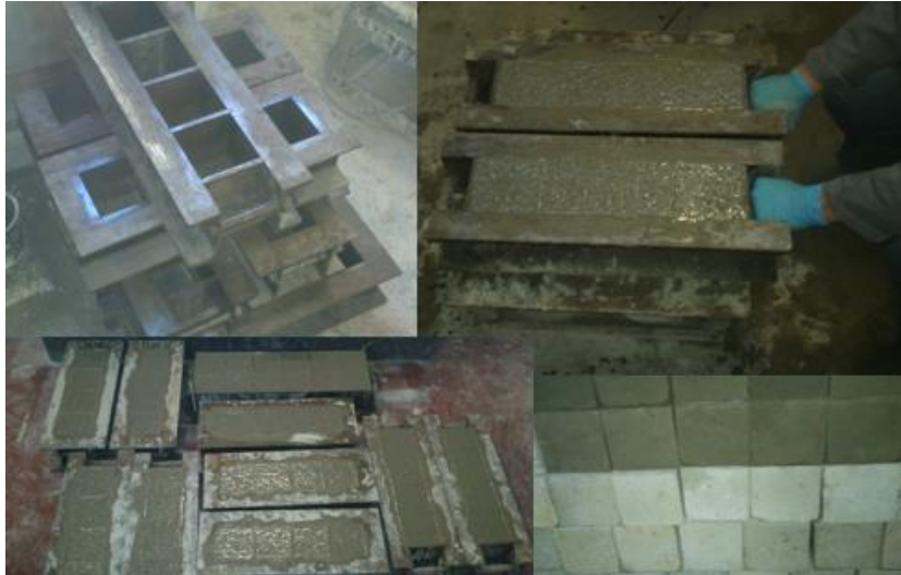
Figura 3.9 – Esquema da preparação, moldagem e desmoldagem dos provetes
