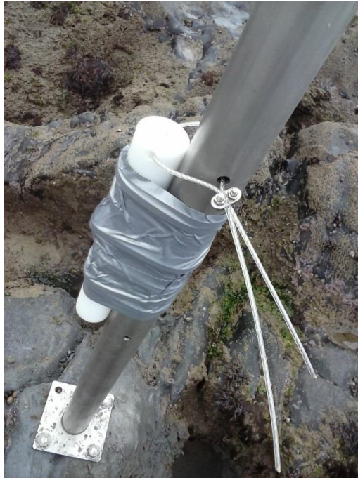
Figura 10 4º Passo, sensor envolto em fita tipo "Americana"
