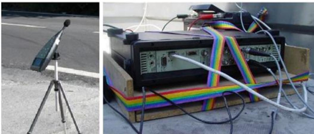
Figura 5 – Sonómetro e Pulse
