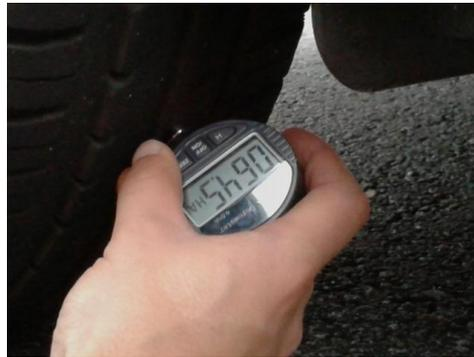
Figura 22 – Medição da dureza do pneu, com auxílio de um durómetro
