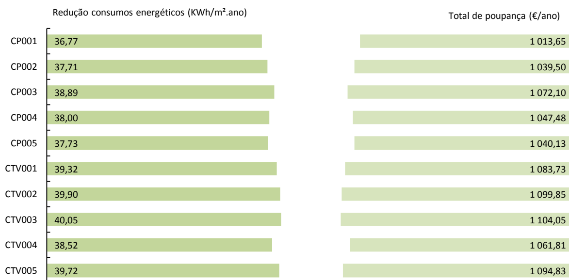
Figura 88 – Redução dos consumos energéticos e ganhos anuais com a integração coletores na cobertura em conjunto com as medidas de reforço do isolamento térmico no edifício
