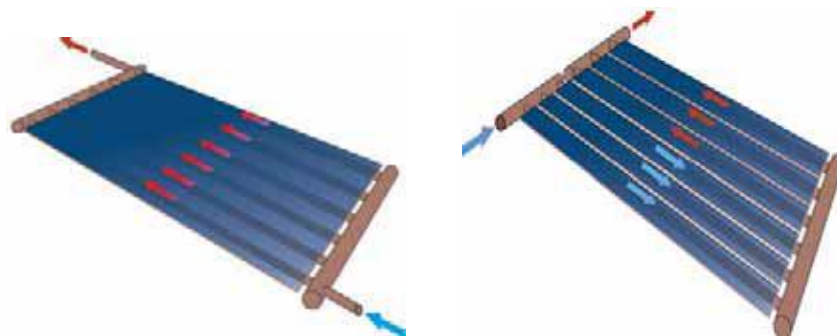
Figura 15 - Absorvedor de superfície-total (GREENPRO, 2004)
