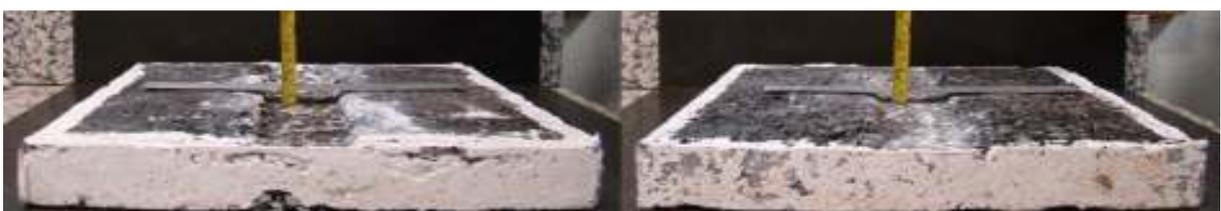
Figura 4.36 – Deformação permanente das lajetas de BE no fim do ensaio WTT
