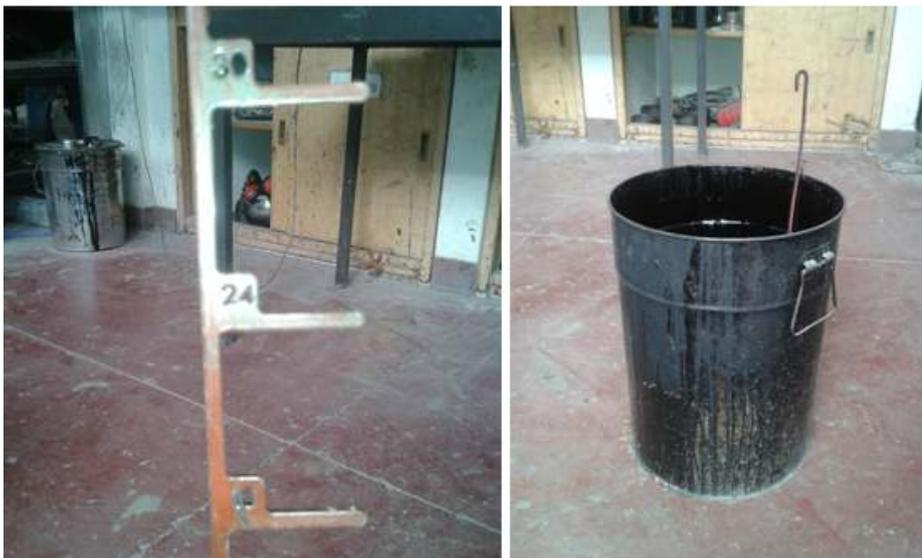
Figura 3.2 – Escala e balde utilizado para o betume-espuma
