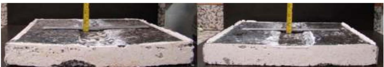
Figura 4.35 – Deformação permanente das lajetas de BC no fim do ensaio WTT
