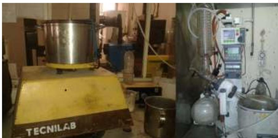
Figura 3.15 – Picnómetro usado para a determinação da BMT de misturas betuminosas (Esquerda) e equipamento de produção de vácuo (Direita)
