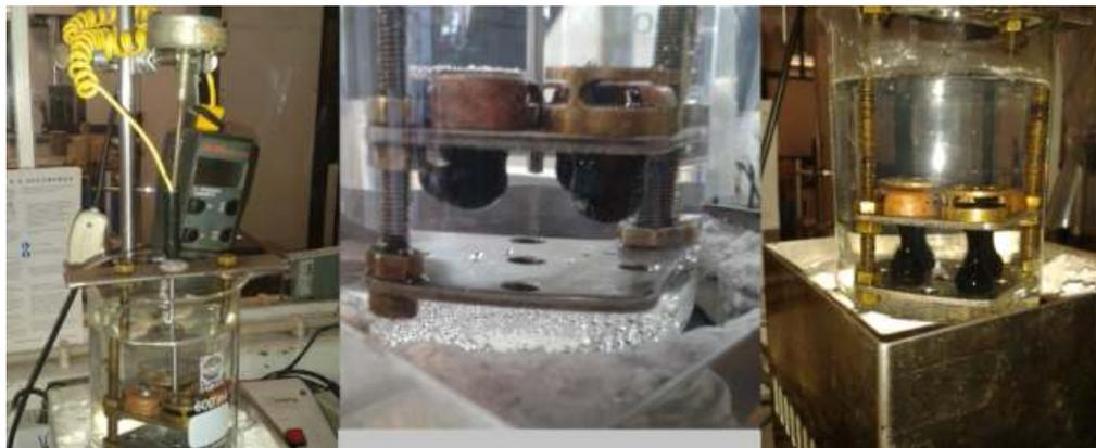
Figura 3.3 – Várias fases do ensaio Anel e Bola: fase inicial do ensaio (esquerda); fase em que o betume começa a deformar com o peso da esfera (centro); fase final do ensaio em que se regista a temperatura a que o betume tocou na parte inferior do suporte (direita)
