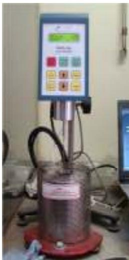
Figura 3.4 – Viscosímetro rotacional de Brookfield
