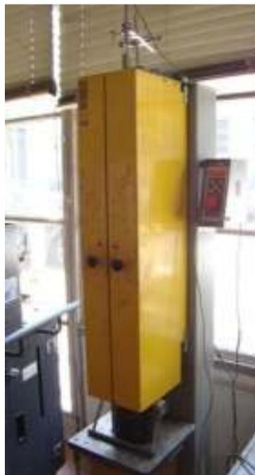
Figura 3.11 – Compactador de Marshall
