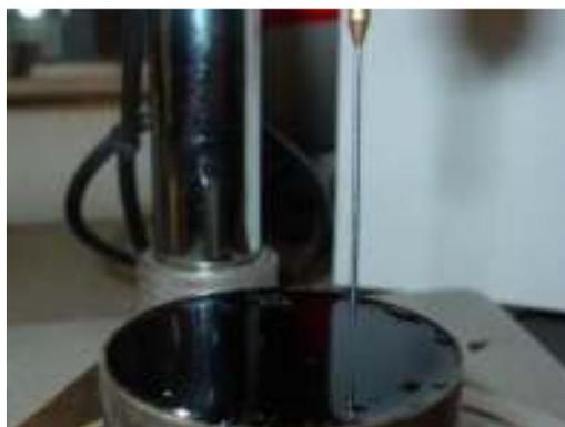
Figura 3.6 – Ensaio de penetração a 25 °C.
