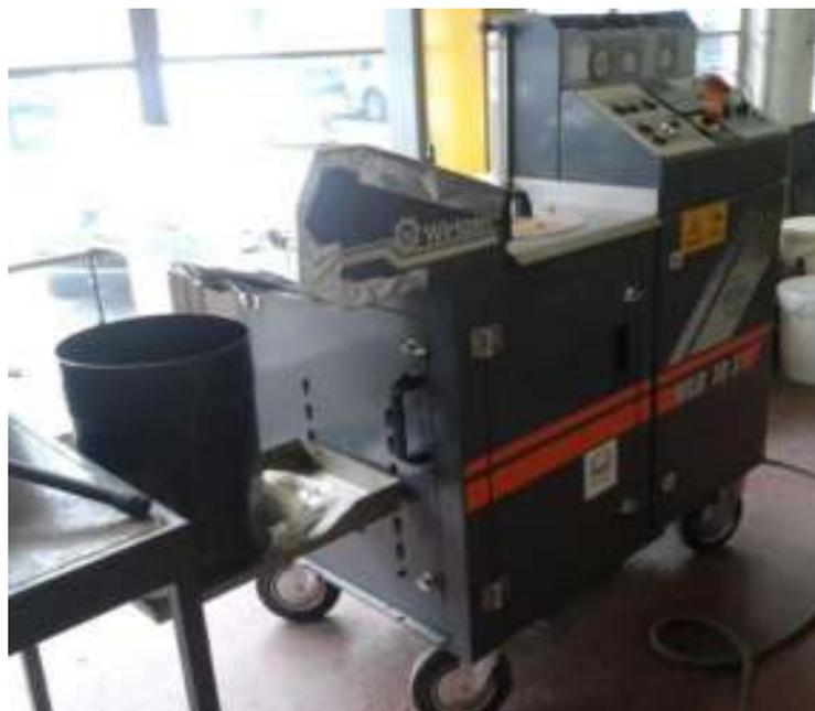
Figura 3.1 – Equipamento laboratorial de produção de betume-espuma (Wirtgen WLB 10 S)
