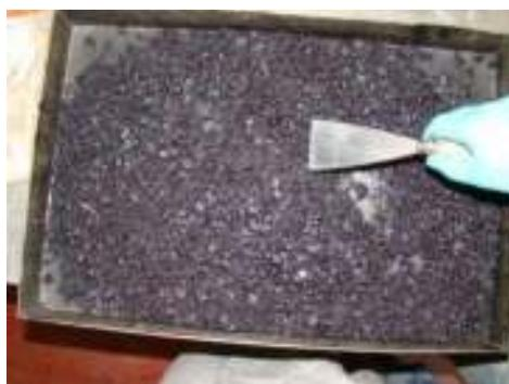
Figura 3.10 – Amostra de mistura betuminosa para ensaios de BMT e percentagem de betume.
