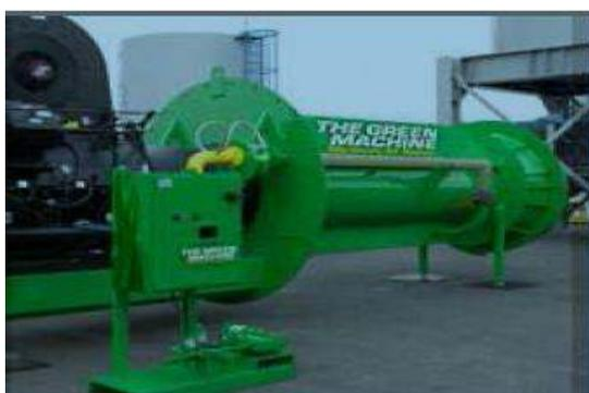
Figura 2.13 – Dispositivo para produção de betume-espuma pelo processo Ultrafoam GX (Ferreira, 2009)
