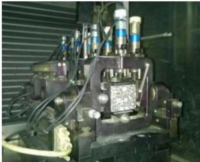
Figura 3.18 – Ensaio do módulo de rigidez
