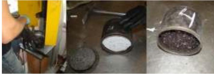
Figura 3.12 – Colocação de papéis para que a amostra não cole ao compactador
