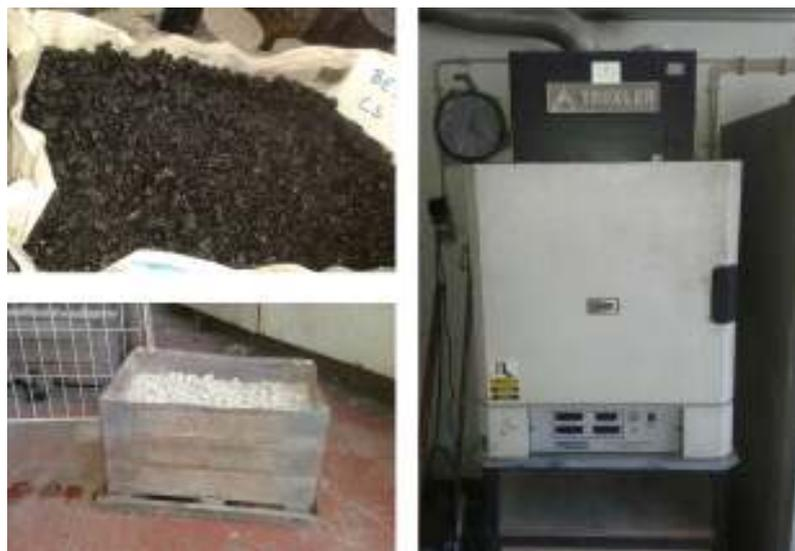
Figura 3.20 – Ensaio de determinação da percentagem de betume: aspeto da mistura inicial (em cima); aspeto da mistura (sem betume) depois da queima, em baixo; Forno incinerador usado para a queima (direita)
