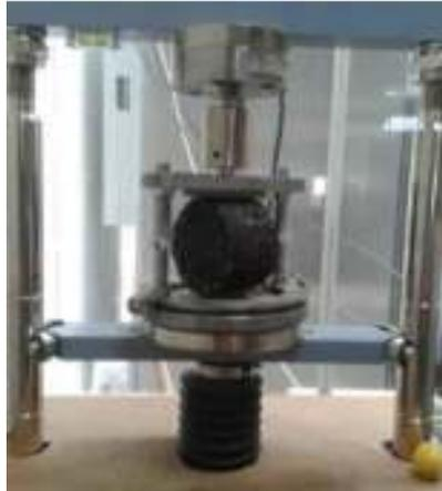
Figura 3.17 – Ensaio de Tração Indireta
