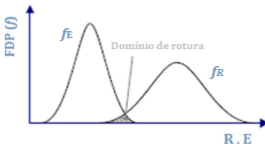
Figura 4.5 - Função densidade de probabilidade para Resistências (R) e Ações / Efeitos (E) (adaptado de Teixeira, 2012)
