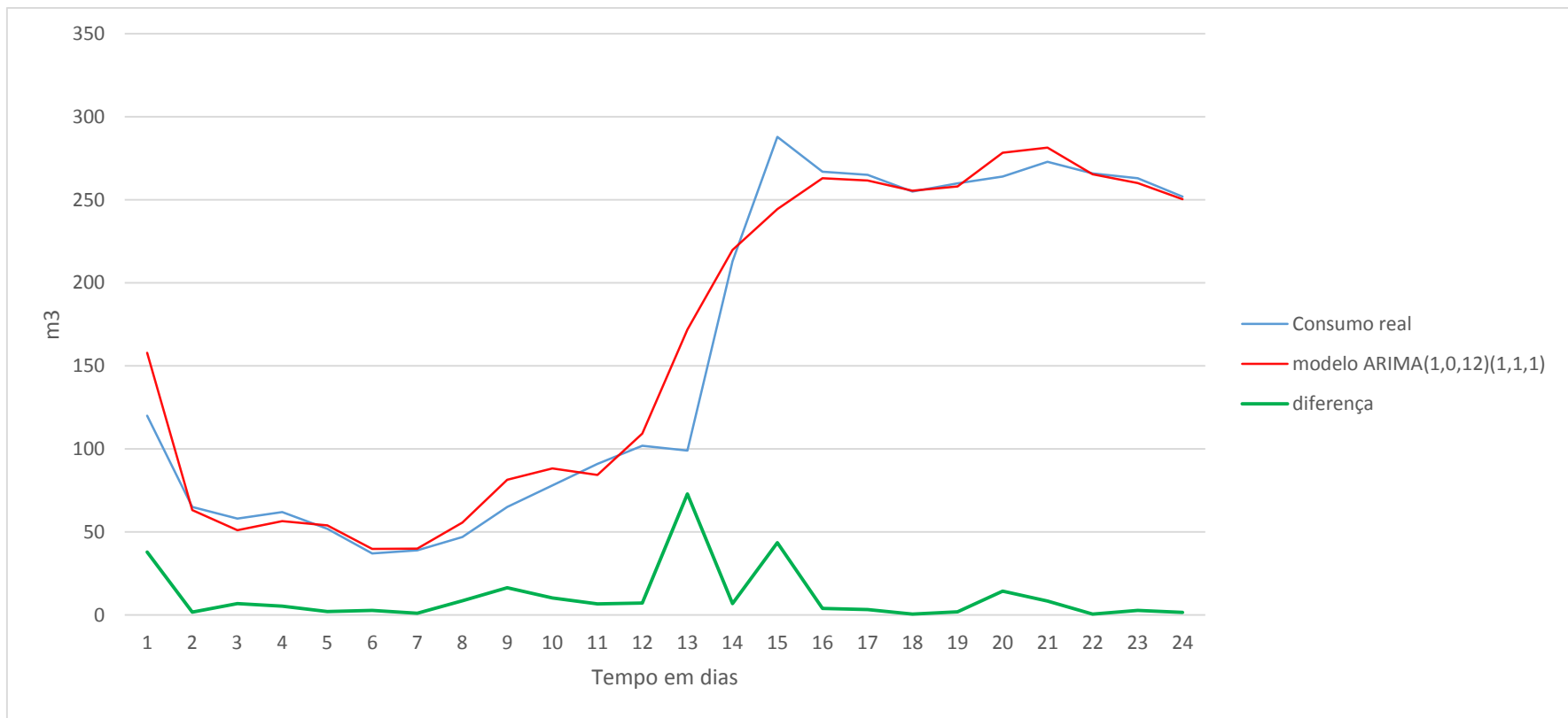
Figura 18 -Modelo 2 de previsão em SPSS, para o perfil “Fim de semana”, previsão para 24 horas
