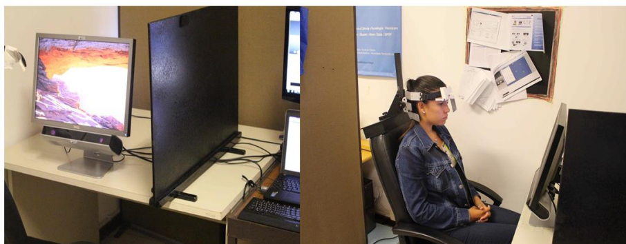
Figura 3.2: Material utilizado na experiência. A imagem do lado esquerdo ilustra a disposição de algum material (eye-tracker incorporado no ecrã ligado a dois computadores (Um com o sistema do eye-tracker e o outro com o software Matlab)). A imagem da direita ilustra o participante já disposto para dar início à experiência, sentado numa cadeira com suporte de cabeça.
