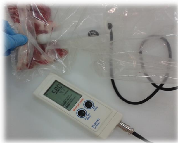
Figura 11 - Medição de pH, dentro do saco retráctil, da amostra recolhida da peça de bovino.
