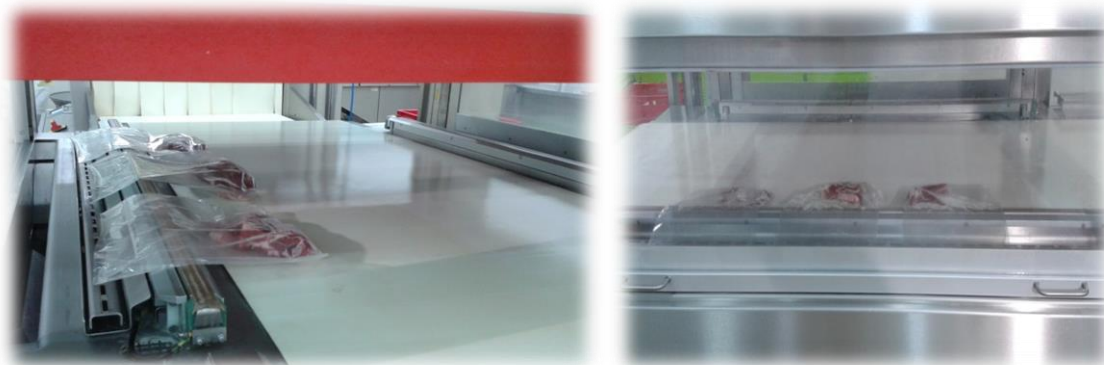
Figura 12 - Etapa da embalagem a vácuo que consiste na remoção do ar de dentro do saco, a uma pressão conhecida, e selagem imediata do saco.
