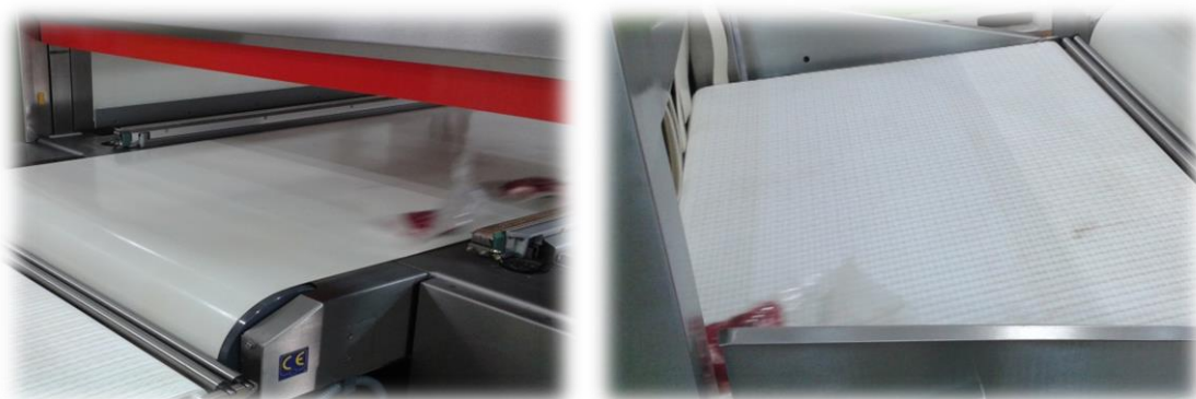
Figura 13 - Passagem do conjunto, devidamente selado, da máquina de embalagem a vácuo para o depósito com água a 82 °C.
