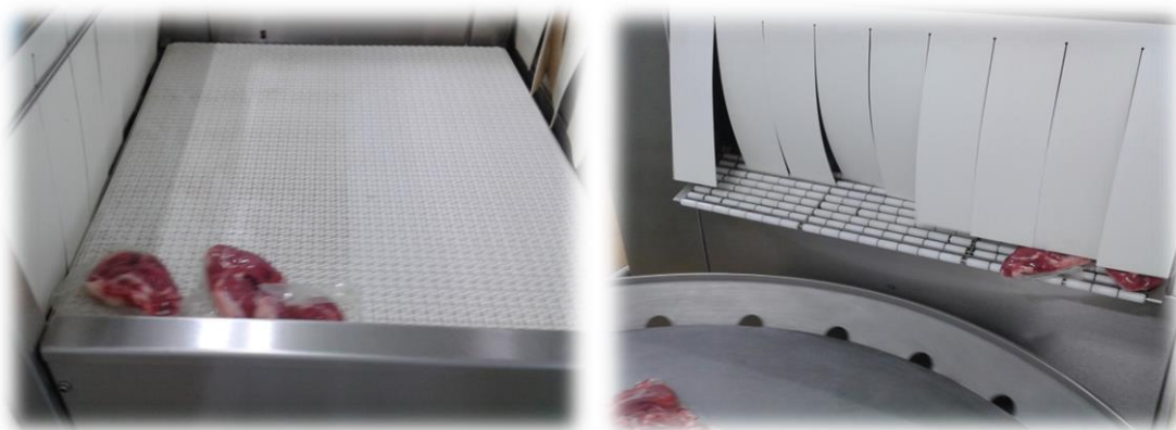
Figura 14 - Última etapa do processo de embalagem, em que ocorre a passagem da embalagem do depósito de água quente para uma máquina de secagem de embalagens.
