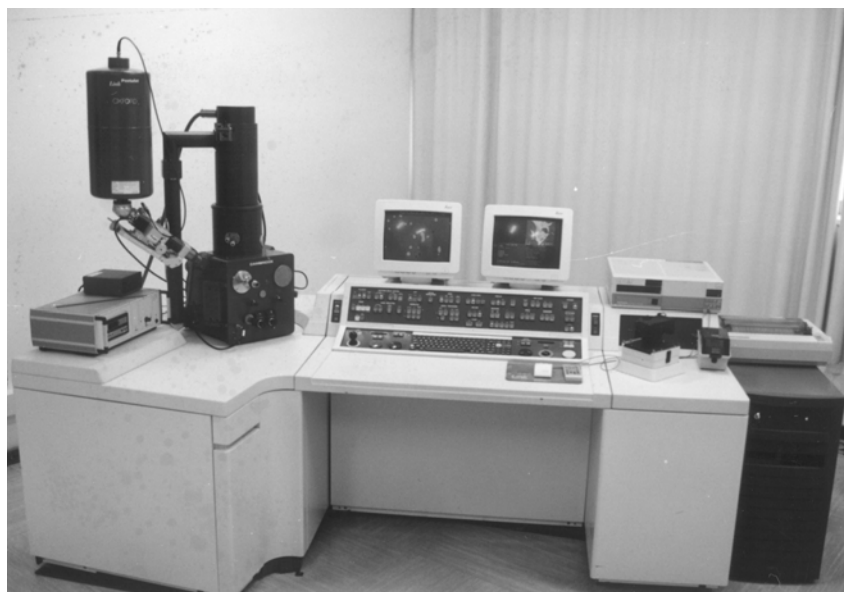
Figura 3.2.1 – Microscópio electrónico de varrimento, modelo LEICA S360.
