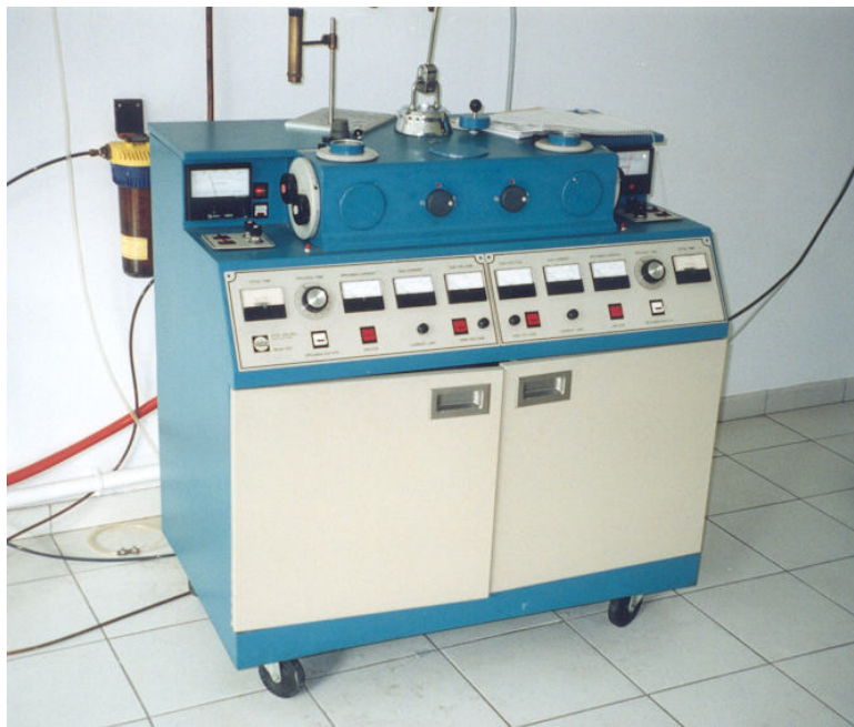
Figura 3.3.5 – Equipamento de desbaste iónico Gatan Dual Ion Mill Model 600.
