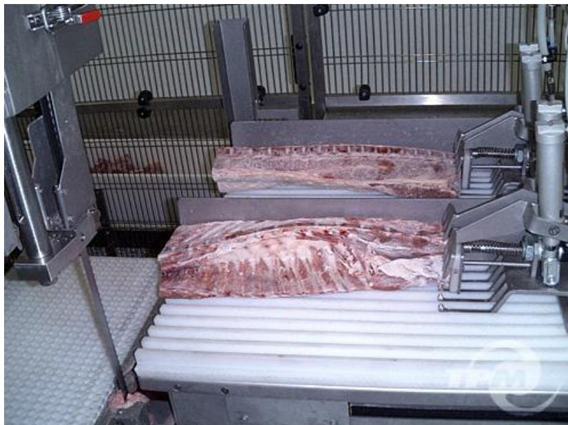
**Figura 2.7** – Mesa móvel e garras de fixação do produto. Adaptado de TPM [19].
