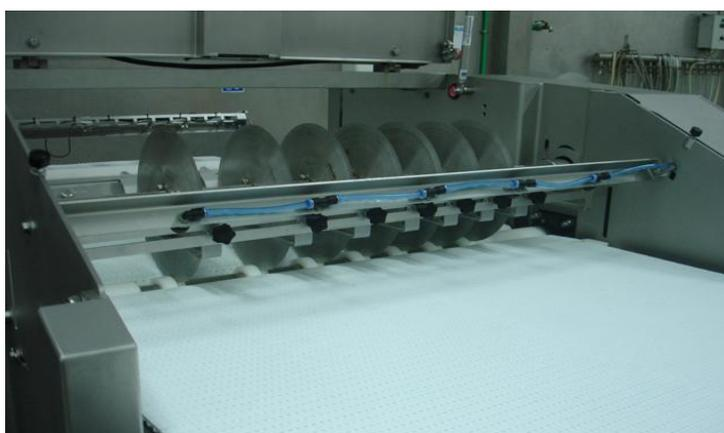
**Figura 2.11** - Máquina de Corte Bacalhau Cru Marel StripCutter.
