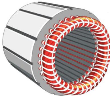
Figura 2.2 – Representação de um estator. Fonte: [http://www.eup-network.de/fileadmin/user\\_upload/Produktgruppen/Lots/Final\\_Documents/Lot11\\_Motors\\_FinalReport.pdf](http://www.eup-network.de/fileadmin/user_upload/Produktgruppen/Lots/Final_Documents/Lot11_Motors_FinalReport.pdf) [9].
