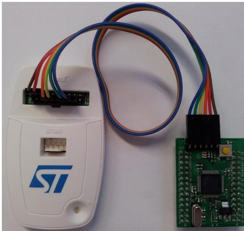
Figura 4.8 – *ST-LINK/V2* e a conexão à placa desenvolvida.
