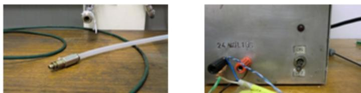
Figura 8 – Mangueira retirada e fonte de alimentação desligada.
