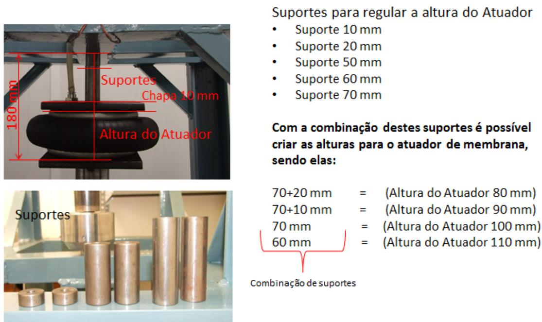
Figura. 3.5- Suportes para definir altura do atuador de membrana
