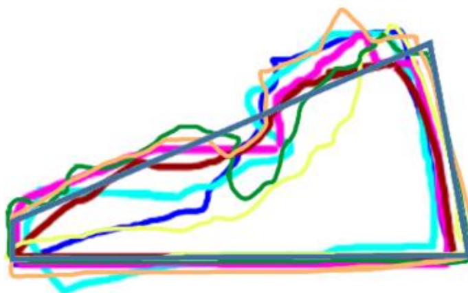
Figura 3.5 - Contornos das barreiras deformadas para o segmento C. A linha azul em forma de trapézio é a barreira deformada padrão para o segmento.
