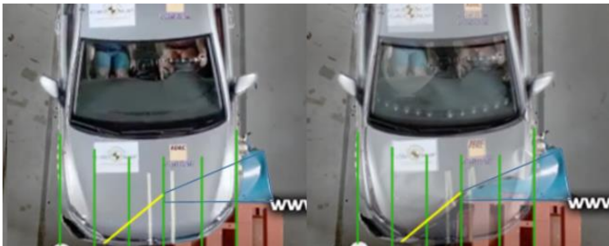
Figura 3.11 - Sobreposição dos dois frames do Volkswagen Golf 2012 no AdobePhotoshop (na figura à direita o frame 1 têm opacidade de 50%).
