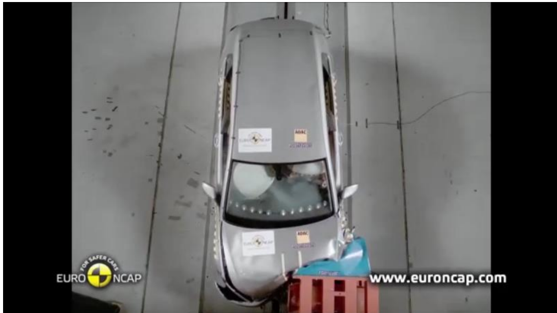
Figura 3.10 – Crash test do Volkswagen Golf 2012 pela Euro NCAP (deformação máxima antes do desvio).
