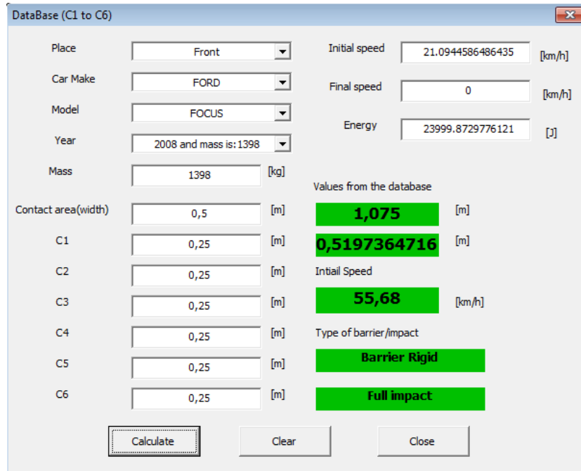
Figura 4.3- Execução do programa para o modelo Ford Focus 2008 crash test da NHTSA.
