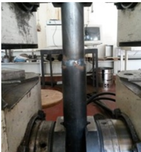
Figura 4-6 – Colocação do provete
