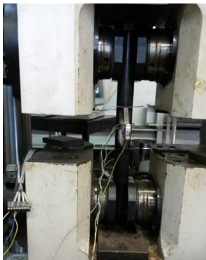
Figura 4-3 – Colocação dos extensómetros
