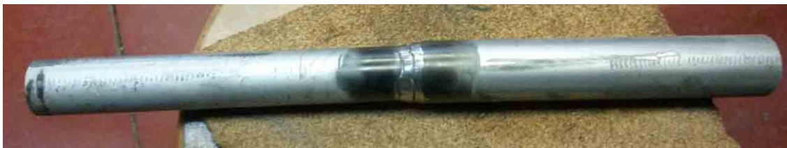
Figura A-1 – Soldadura afagada
