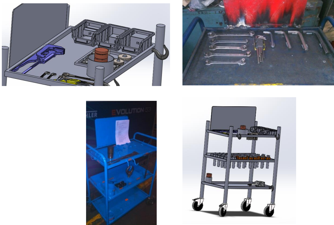
Figura 41 - Carrinho de ferramentas construído
