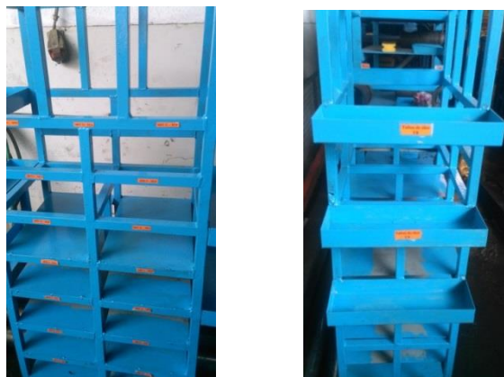
Figura 61 - Estante das cavilhas com local para tubos de água e óleo.
