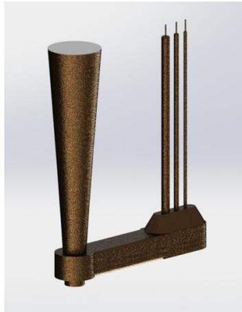
Figura 43: Varetas e gitos da coquilha de vazamento à nascente
