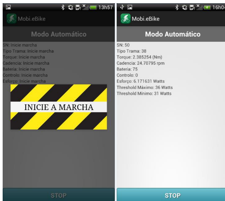
Figura 4.34. Interface da opção de controlo automático.
