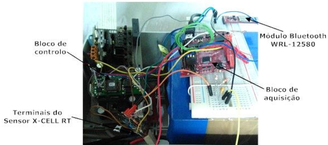
Figura 4.15. Hardware do sistema na bicicleta.
