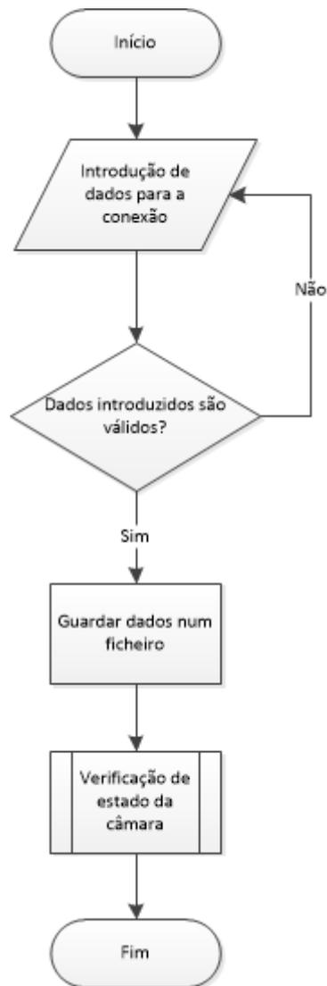
Figura 19 – Processo de adição de uma câmara
