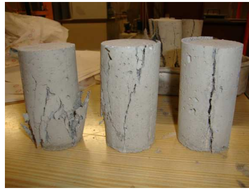
Figura 4.18 – Modos de rotura em compressão típicos dos provetes de ARMO-crete w
