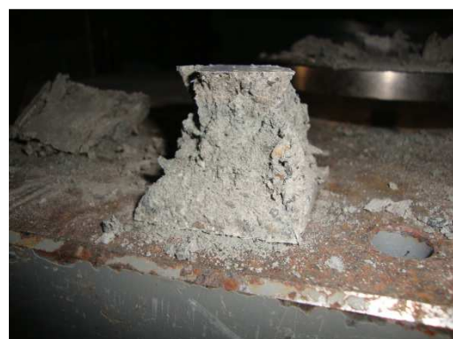
Figura 4. 24 – Modos de rotura em compressão típicos dos provetes de ARMO-crete w
