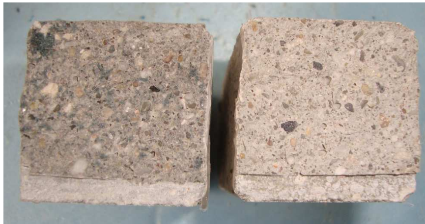
Figura 5.26 - Modo de rotura em flexão dos provetes de ARMO-crete
