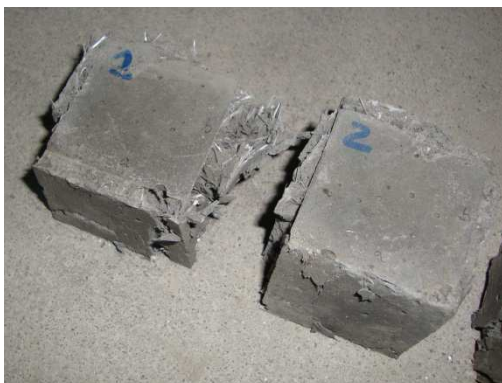
Figura 4. 21 – Modos de rotura em compressão típicos dos provetes de FRCC-PAN
