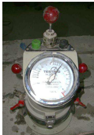
Figura 3.3 - Aerómetro para argamassa
