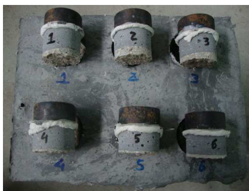
Figura 5.30 – Modos de rotura dos provetes tijolo rebocado/FRCC-GF
