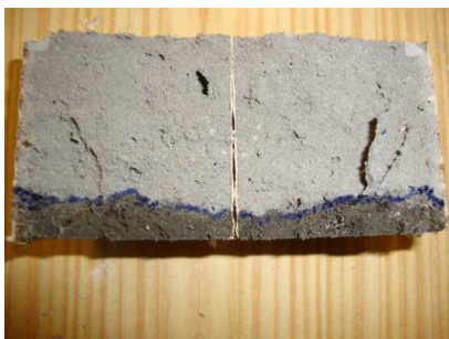
Figura 5.10 - Penetração da solução em provete de FRCC-PVA
