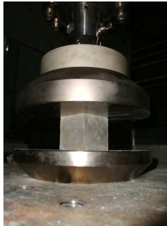
Figura 4.19 – Ensaio de resistência à compressão dos provetes cúbicos
