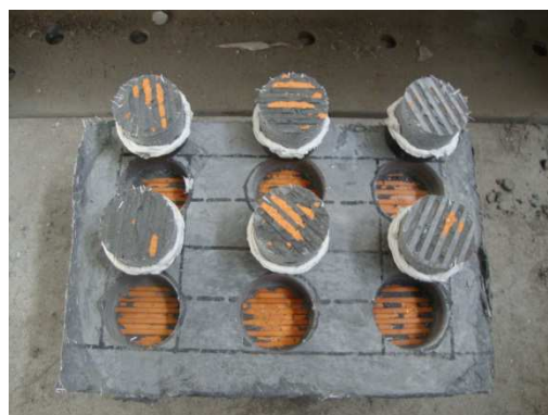
Figura 5.29 – Modos de rotura dos provetes tijolo/FRCC-GF
