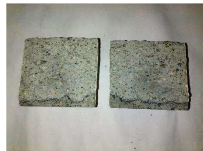
Figura 5.11 - Penetração da solução em provete de ARMO-crete w
