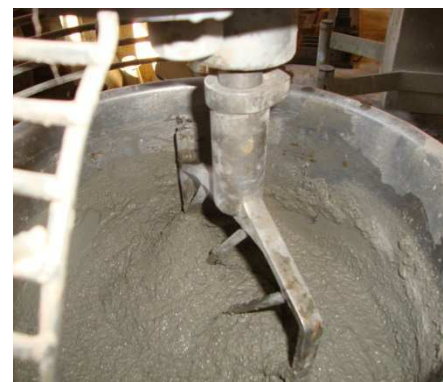
Figura 2.5 – Amassadura de ARMO-crete w
