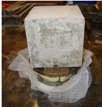
Figura 3.4 – Ensaio para determinação da retenção de água da argamassa
