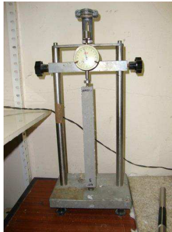
Figura 5.14 – Método de medição da retração das argamassas
