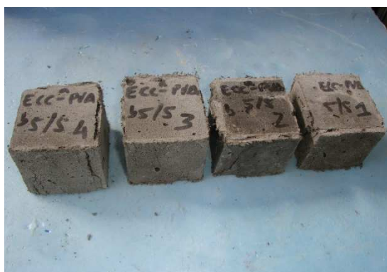
Figura 4.23 – Modos de rotura em compressão típicos dos provetes de FRCC-PVA
