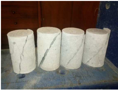
Figura 4.17 – Modos de rotura em compressão típicos dos provetes de FRCC-PVA
