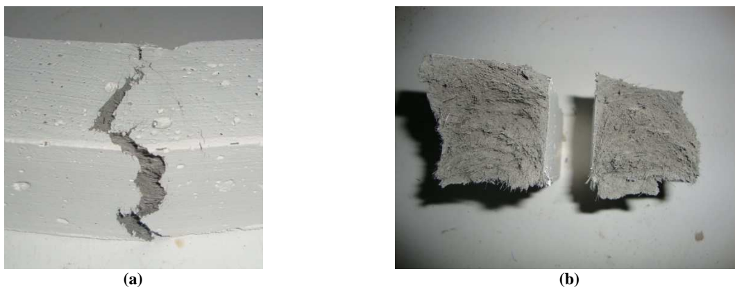
Figura 4.30 – Modo de rotura em flexão dos provetes de FRCC-PAN
