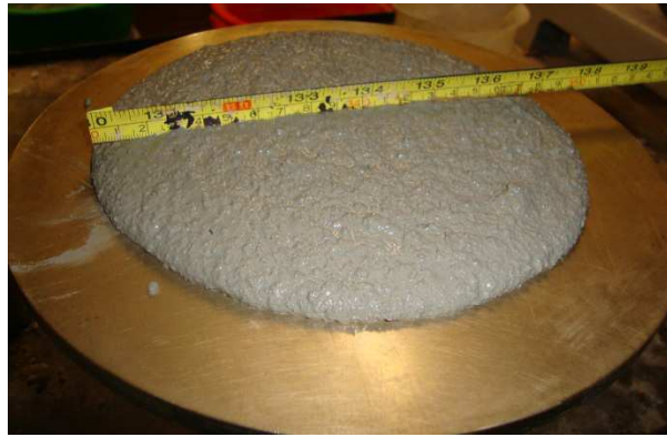
Figura 3.2 – Ensaio de espalhamento
