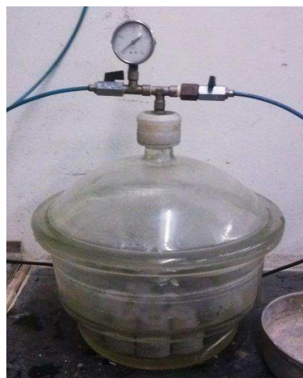
Figura 5.6 – Ensaio para a determinação da porosidade aberta
