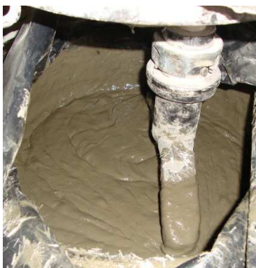
Figura 2.4 – Amassadura de FRCC-PVA
