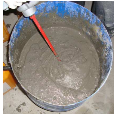
Figura 2.3 – Amassadura de FRCC-GF
