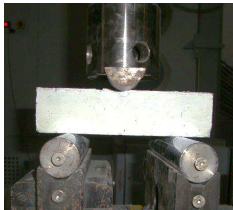
Figura 4.25 – Ensaio de resistência à flexão dos provetes prismáticos
