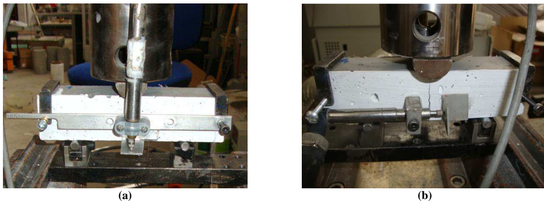
Figura 4.31 – Aplicação da carga e posicionamento dos transdutores
