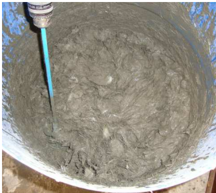
Figura 2.2 – Amassadura de FRCC-PAN
