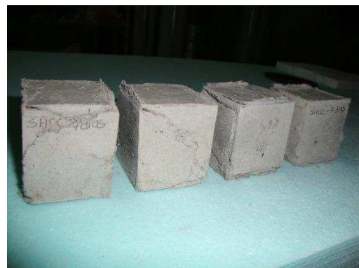
Figura 4.22 – Modos de rotura em compressão típicos dos provetes de FRCC-GF
