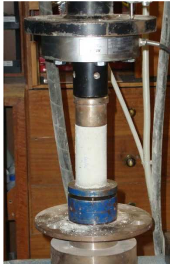
Figura 4.4 – Ensaio de resistência à compressão dos provetes cilíndricos
