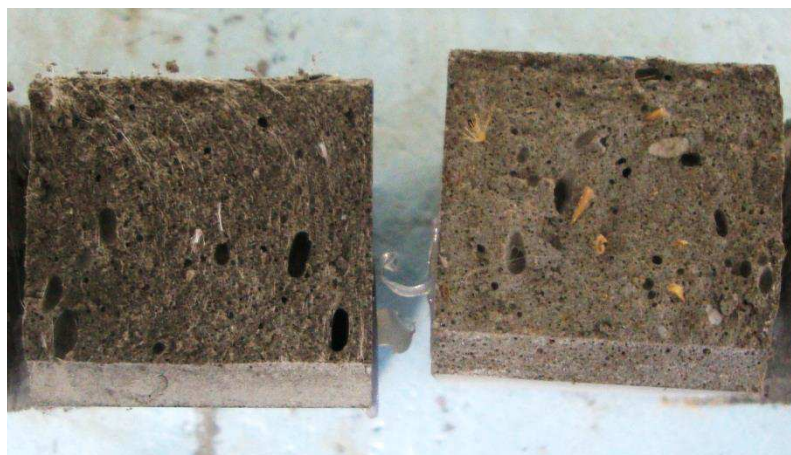
Figura 5.25 - Modo de rotura em flexão dos provetes de FRCC-PVA
