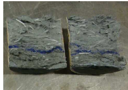
Figura 5.9 - Penetração da solução em provete de FRCC-GF
