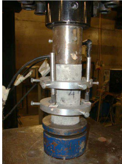
Figura 4.1 – Configuração do ensaio para determinação do módulo de elasticidade
