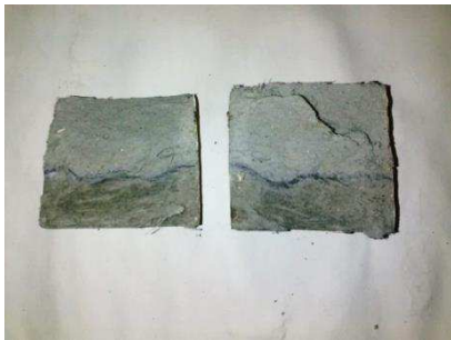
Figura 5.8 - Penetração da solução em provete de FRCC-PAN
