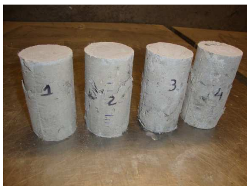
Figura 4.15 – Modos de rotura em compressão típicos dos provetes de FRCC-PAN
