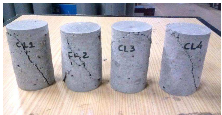
Figura 4.16 – Modos de rotura em compressão típicos dos provetes de FRCC-GF
