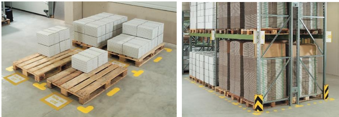
Figura 5 – Exemplos da delimitação de espaços (retirado de Orgatex Lean Visual Management Tools (2012)).
