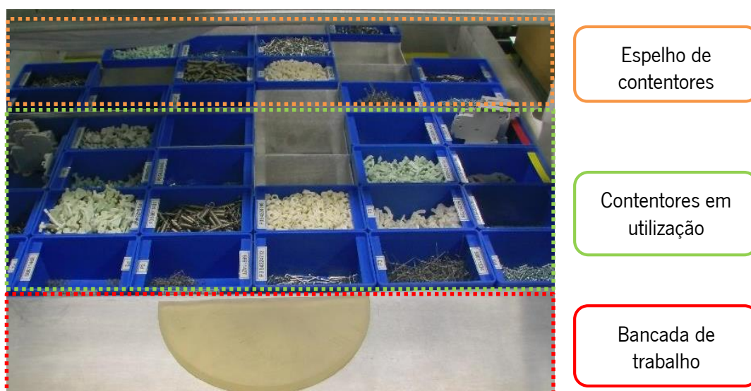
Figura 95 – Constituição do tampo de um posto de trabalho standard .
