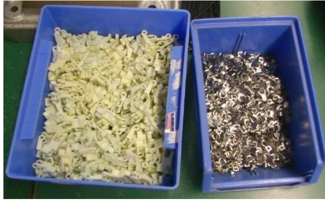
Figura 76 – Falta de identificação de componentes.
