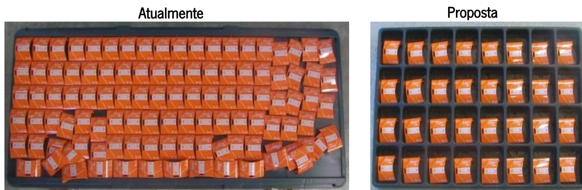
Figura 94 – Alteração do tabuleiro dos vitrinos.
