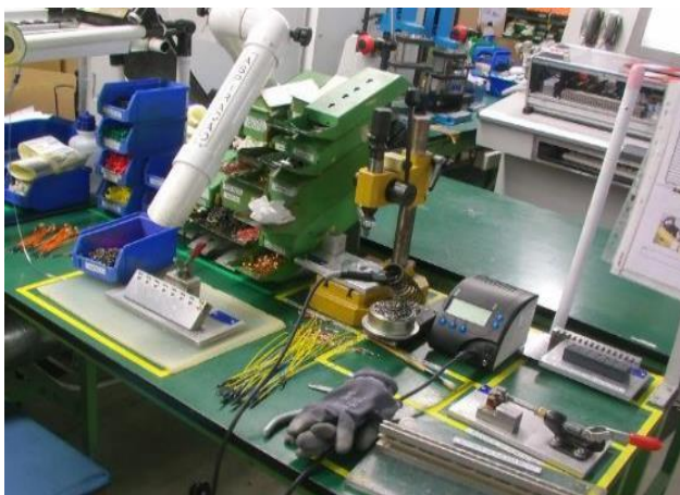
Figura 33 – Posto de soldadura.
