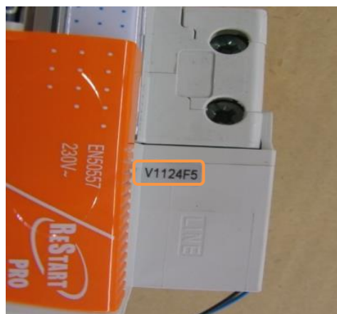
Figura 80 – Substituição da etiqueta pela impressão a laser.
