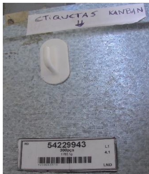
Figura 55 – Pedido de material através de etiqueta kanban .
