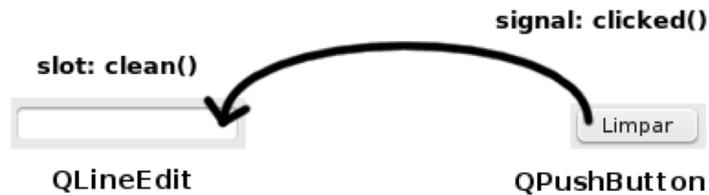
Figura 5.3: Mecanismo signal e slot.
